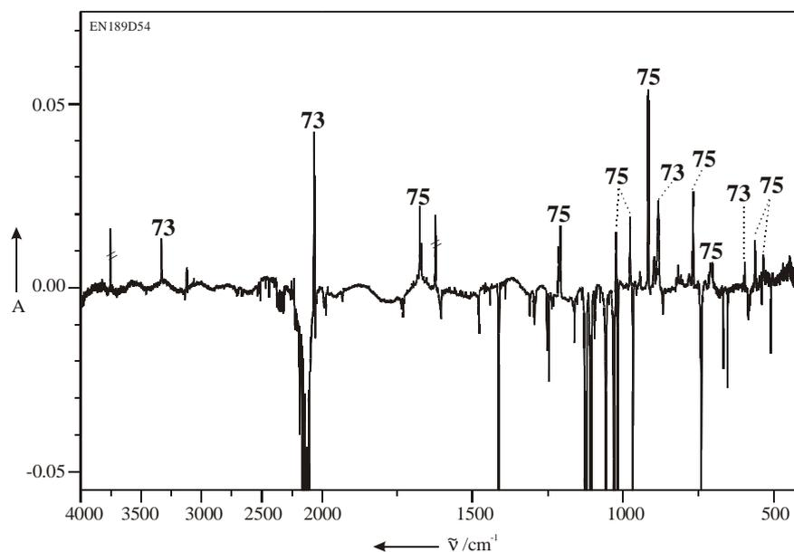
Abbildung 48: Experimentelles (Argon, 10 K) Differenzspektrum nach 35 min Belichtung mit Licht der Wellenlänge  $\lambda = 436 \text{ nm}$ .
