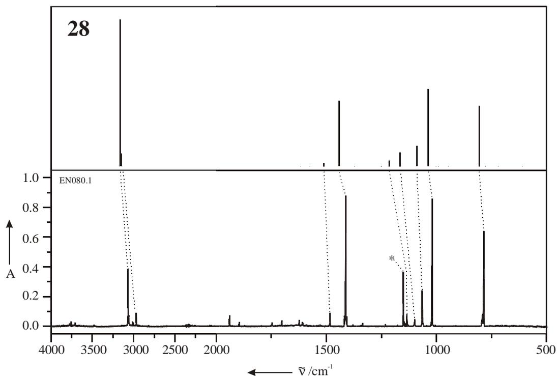
Abbildung 10: Vergleich des berechneten (B3LYP/6-311G(d,p)) IR-Spektrums (oben) von Pyrazin (**28**) mit dem experimentellen Spektrum von matrixisoliertem **28** (Argon, 10 K; unten). Bei der mit einem Stern markierten Bande handelt es sich um einen Kombinationston.
