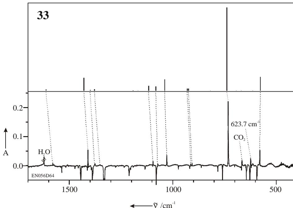
Abbildung 13: Vergleich eines Ausschnittes ( $1700 - 400$   $\text{cm}^{-1}$ ) des berechneten Spektrums (B3LYP/6-311G(d,p)) von 2,3-Dihydroimidazol-2-yliden (**33**) mit dem experimentellen Differenzspektrum nach 20 min Belichtung von Imidazol-2-carbonsäure (**36**) mit  $\lambda = 254$  nm.
