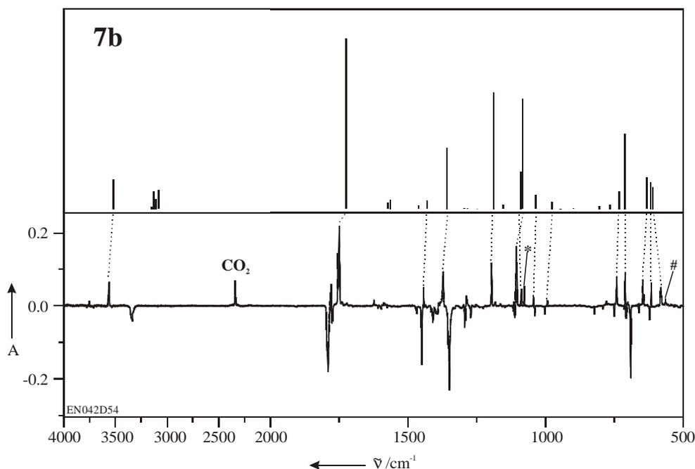
Abbildung 4: Vergleich des nach 20 min Belichtung von 7 mit  $\lambda = 254$  nm erhaltenen Differenzspektrums<sup>[d]</sup> (unten) mit dem berechneten (BLYP/6-31G(d)) IR-Spektrum von 7b (oben). (\* 1078.0, # 565.4  $\text{cm}^{-1}$ , s. Text).
