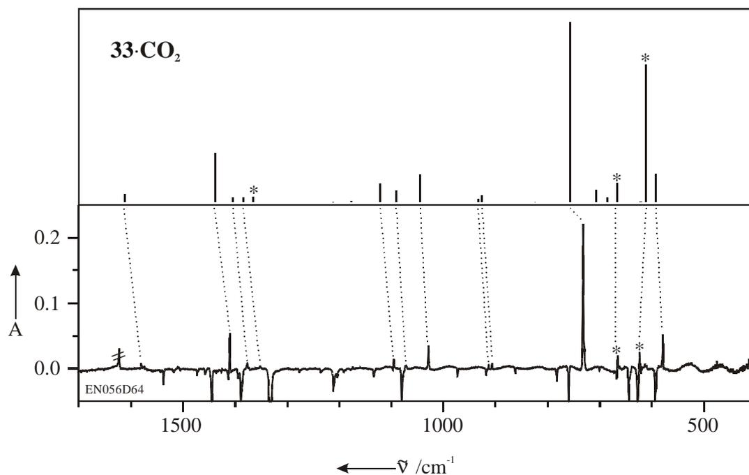
Abbildung 15: Vergleich eines Ausschnitts ( $1700 - 400 \text{ cm}^{-1}$ ) des experimentellen Spektrums nach Belichtung von Imidazol-2-carbonsaure (**36**) mit  $\lambda = 254 \text{ nm}$  mit dem berechneten (B3LYP/ 6-311G(d,p)) Spektrum von  $33 \cdot \text{CO}_2$ . Banden, die durch den  $\text{CO}_2$ -Liganden verursacht werden, sind mit einem Stern markiert.
