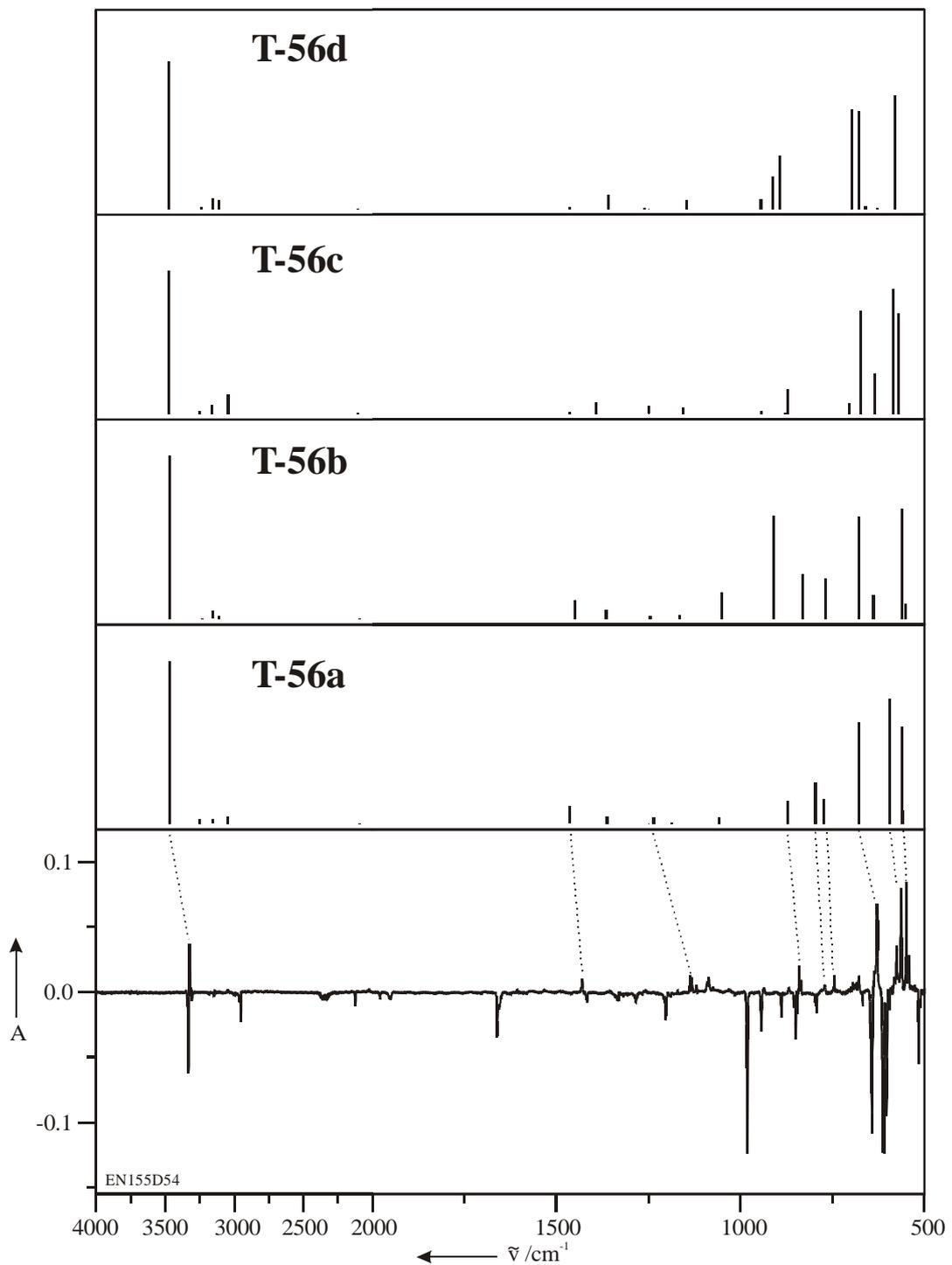
Abbildung 30: Experimentelles Differenzspektrum (Produktbanden zeigen nach unten) nach Sekundärbestrahlung mit  $\lambda = 436 \text{ nm}$  (Argon, 10 K, unten) und Vergleich mit den berechneten IR-Spektren (B3LYP/6-311+G(d,p)) der 4 möglichen Rotamere des 3-Penten-1-in-5-ylidens (T-56).
