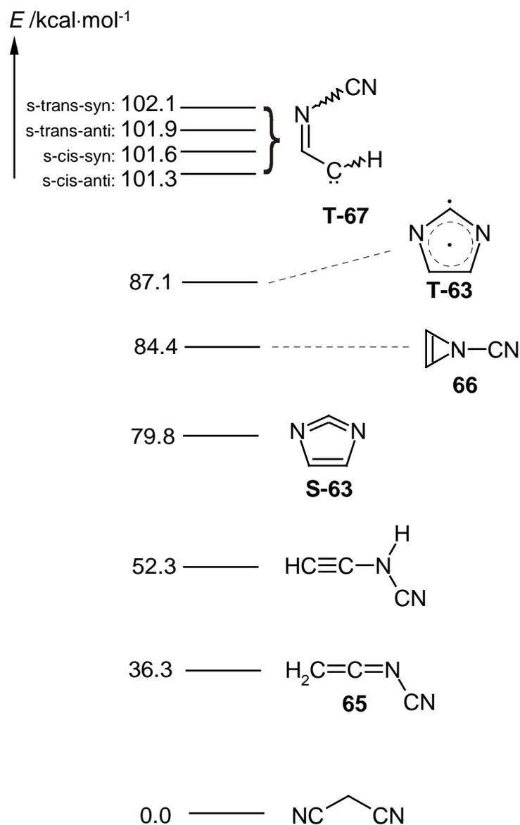
Schema 16: Relative Energien (MP4SDTQ(fc)/6-311+G(d,p)//B3LYP/6-311+G(d,p), ohne Berücksichtigung der Nullpunktsenergie, in  $\text{kcal}\cdot\text{mol}^{-1}$ ) ausgewählter Isomere der Zusammensetzung  $C_3H_2N_2$ .
