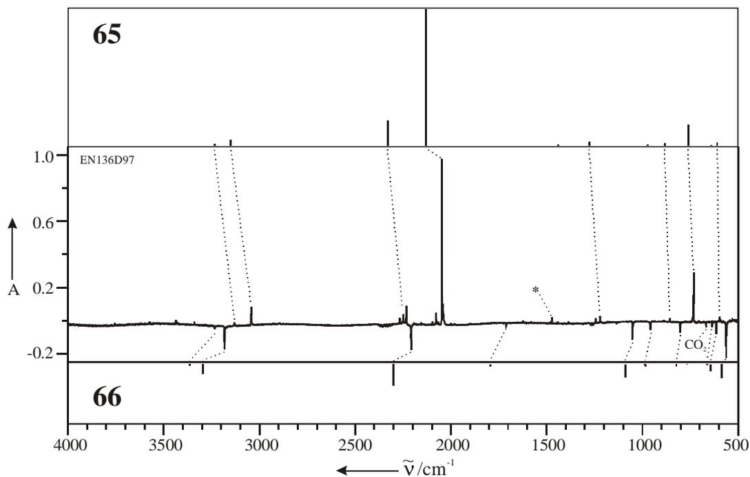
Abbildung 36: Vergleich des experimentellen Differenzspektrums (Argon, 10 K, Mitte) mit dem berechneten (B3LYP/6-311+G(d,p)) IR-Spektrum von **66** (unten) und **65** (oben). Das experimentelle Spektrum ist ein Differenzspektrum der Photoreaktion **66**  $\rightarrow$  **65** bei Bestrahlung mit  $\lambda = 254$  nm. Die mit einem Stern markierte Bande ist ein Oberton der Bande bei  $733$   $\text{cm}^{-1}$ .
