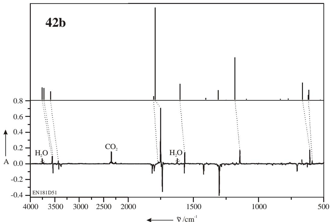
Abbildung 19: Experimentelles Differenzspektrum (Argon, 10 K; unten) nach 3 h Belichtung von **42a** mit  $\lambda = 254 \text{ nm}$  und Vergleich mit dem berechneten IR-Spektrum (B3LYP/6-311+G(d,p); oben) von **42b**.
