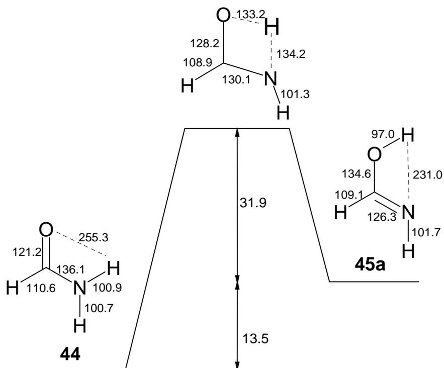
Schema 11: Reaktionsschema für die Isomerisierung von Formamid (**44**) zu Formiminsäure (**45a**) (Energien in kcal mol<sup>-1</sup>, Bindungslängen in pm).
