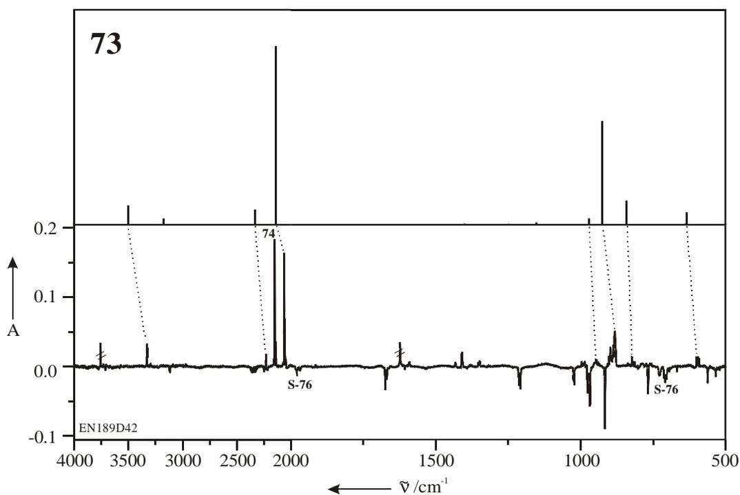
Abbildung 45: Vergleich des experimentellen (Argon, 10 K) Differenzspektrums der Bestrahlung von 2-Cyan-2*H*-aziren (**75**) mit  $\lambda = 254\text{ nm}$  mit dem berechneten Spektrum von 2-Cyanketenimin (**73**).
