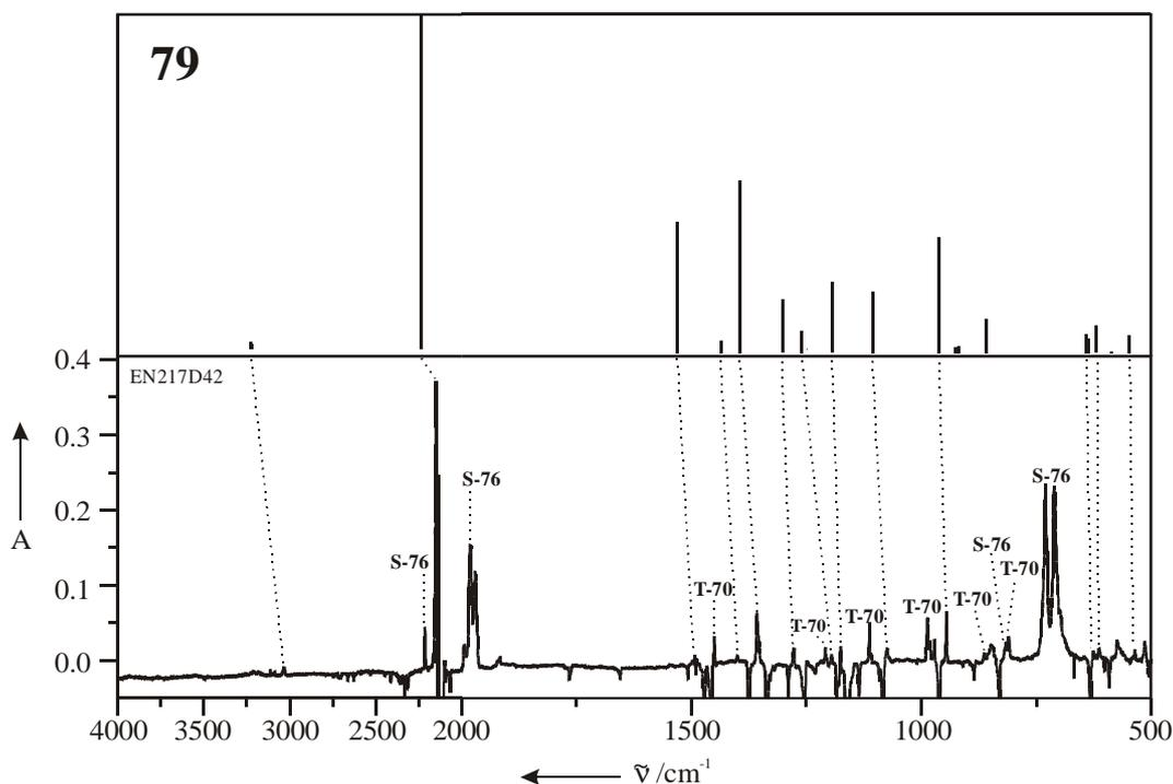
Abbildung 46: Vergleich des experimentellen (Argon, 3.5 Vol.-% CO, 10 K) Differenzspektrums nach 10 min Belichtung von **69** mit  $\lambda = 313$  nm mit dem berechneten (B3LYP/6-311+G(d,p)) IR-Spektrum von 4*H*-Imidazol-4-ylidenketen (**79**).
