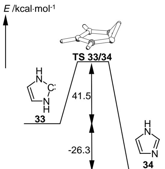
Schema 5: Berechnete Energie (B3LYP/6-311G(d,p); in kcal·mol<sup>-1</sup>) für die Isomerisierung von 2,3-Dihydroimidazol-2-yliden (**33**) zu Imidazol (**34**).
