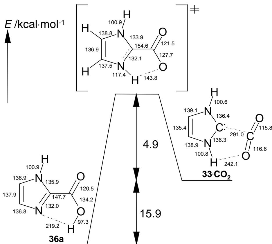
Schema 7: Berechnete Energien (B3LYP/6-311G(d,p)) der Decarboxylierungsreaktion von Imidazol-2-carbonsäure (**36**) in  $\text{kcal} \cdot \text{mol}^{-1}$ ; Bindungslängen und Abstände in pm.
