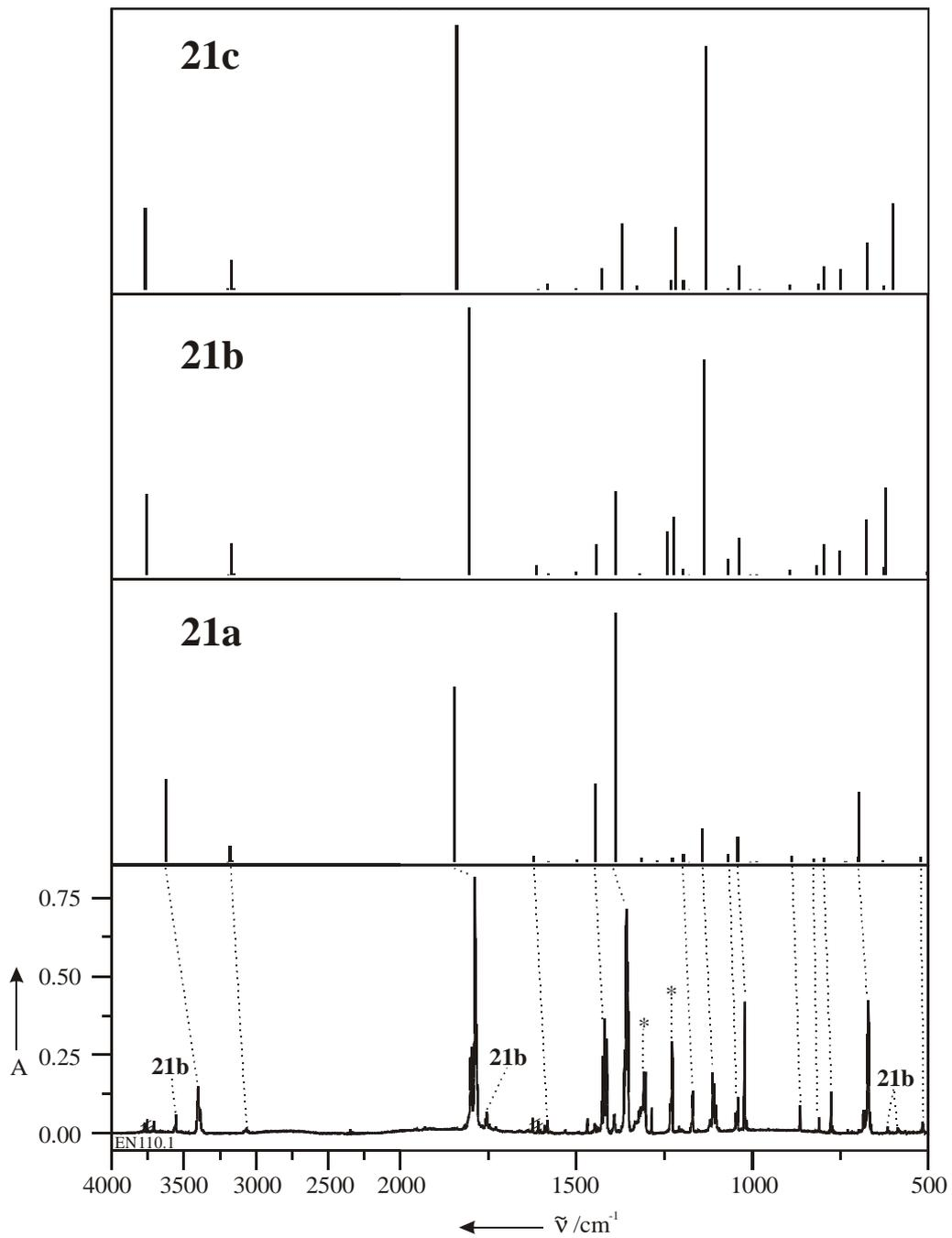
Abbildung 7: Vergleich des Spektrums von matrixisoliertem **21** (Argon, 10 K) mit den berechneten Spektren von **21a** – **c** (BLYP/6-31G(d)); bei den mit Stern markierten Banden handelt es sich vermutlich um Ober- und Kombinationstöne.
