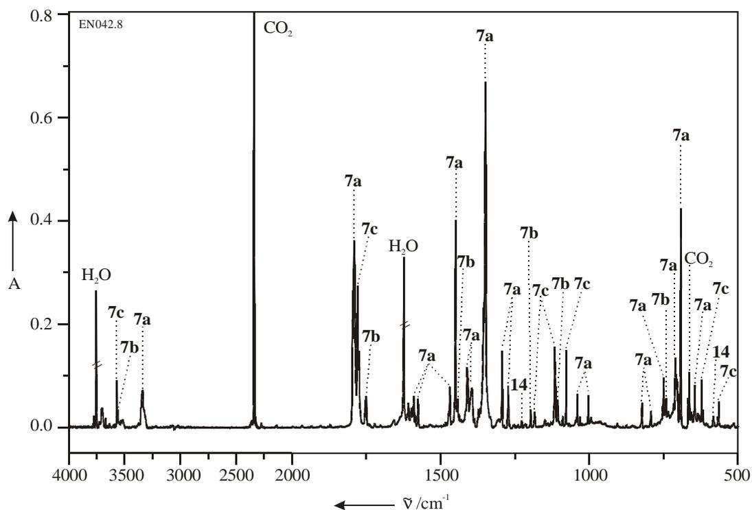
Abbildung 5: Experimentelles IR-Spektrum von **7** (Argon, 10 K) nach 6 h Belichtung mit  $\lambda = 254$  nm.
