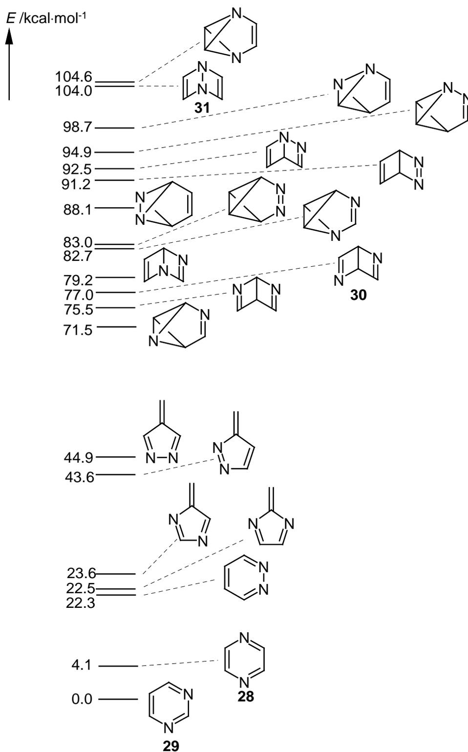
Schema 3: Berechnete (B3LYP/6-311G(d,p)) relative Energien von Isomeren der Elementarzusammensetzung C<sub>4</sub>H<sub>4</sub>N<sub>2</sub> in kcal·mol<sup>-1</sup>.
