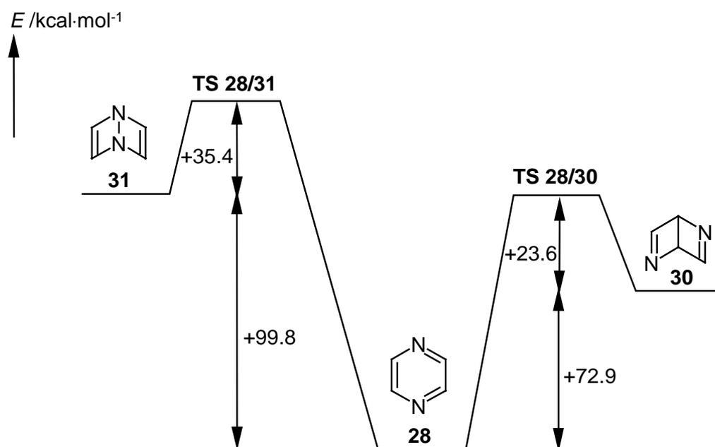
Schema 4: Berechnete (B3LYP/6-311G(d,p)) Energien (in kcal·mol<sup>-1</sup>) für die Isomerisierungsreaktionen von Pyrazin (**28**) zu den beiden Diazabicyclohexadienen **30** und **31**.
