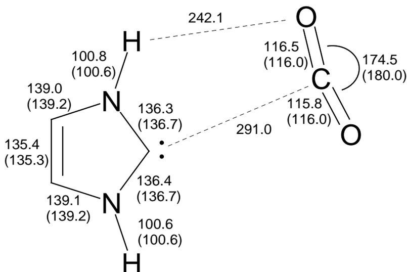
Abbildung 14: Berechnete (B3LYP/6-311G(d,p)) Geometrie des  $\text{CO}_2$ -Komplexes von 2,3-Dihydroimidazol-2-yliden ( $\text{33} \cdot \text{CO}_2$ ); Bindungsabstände in pm, Bindungswinkel in °; Abstände und Winkel in Klammern beziehen sich auf die freien Komponenten **33** und  $\text{CO}_2$ .
