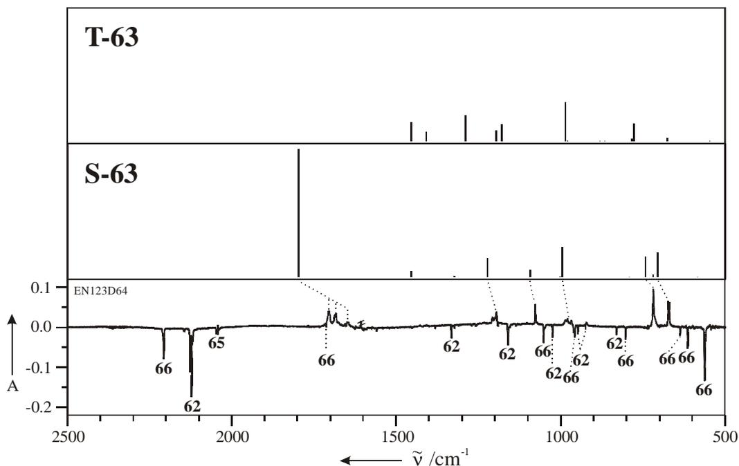
Abbildung 34: Vergleich eines Ausschnittes (2500 – 500 cm<sup>-1</sup>) des experimentellen Differenzspektrums der Photoreaktion **63** → **62** + **65** + **66** mit dem berechneten (B3LYP/6-311+G(d,p)) IR-Spektrum von **S-63** (Mitte) und **T-63** (oben). Produktbanden zeigen nach unten.
