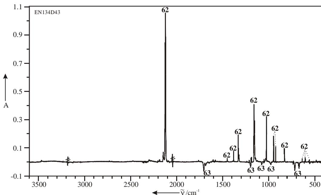
Abbildung 37: Experimentelles Differenzspektrum (Argon, 10 K) nach 30 min Tempern der Matrix bei 25 K.
