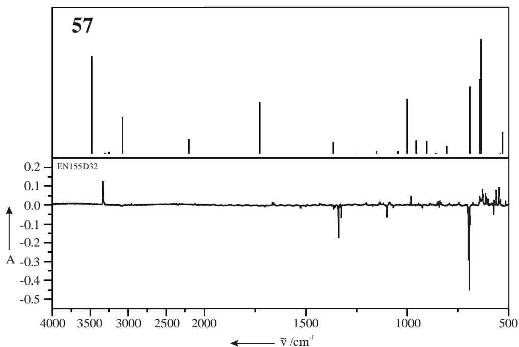
Abbildung 28: Vergleich des experimentellen Differenzspektrums nach 10 min Belichtung von Cyclopentadienyliden (**T-5**) mit  $\lambda = 313$  nm mit dem berechneten (B3LYP/6-311+G(d,p)) Spektrum von 3-Ethynylcyclopropen (**57**).
