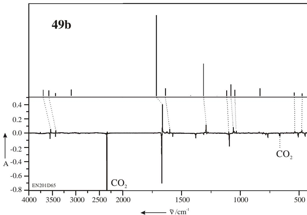
Abbildung 22: Vergleich des experimentellen Differenzspektrums der Photoreaktion **49a**  $\rightarrow$  **49b** mit dem berechneten (B3LYP/6-311+G(d,p)) IR-Spektrum von **49b**.
