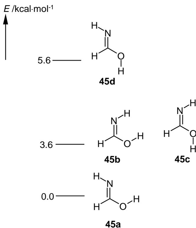
Schema 10: Berechnete relative Energien (B3LYP/6-311+G(d,p); in kcal·mol<sup>-1</sup>) der vier möglichen Konformere von Formiminsäure (**45**).
