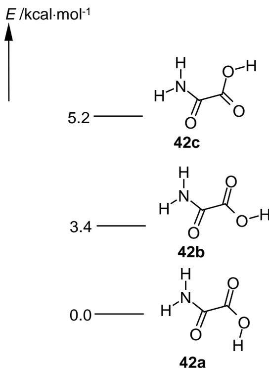
Schema 8: Berechnete (B3LYP/6-311+G(d,p)) Energien (in kcal· mol<sup>-1</sup>) der möglichen Konformere des Oxalsäuremonoamids (**42 a – c**).
