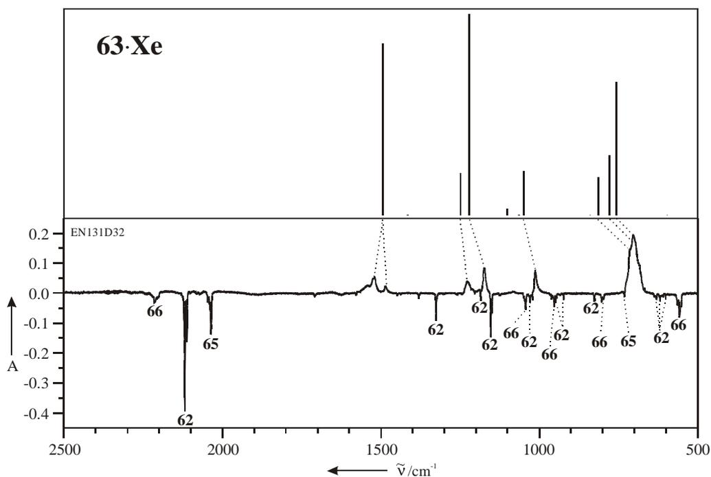
Abbildung 39: Vergleich eines Ausschnittes (2500 – 400  $\text{cm}^{-1}$ ) des experimentellen (Xenon, 10 K, unten) Differenzspektrums der Photoreaktion  $63 \rightarrow 62 + 65 + 66$  bei Bestrahlung mit  $\lambda > 570$  nm mit dem berechneten IR-Spektrum (B3LYP/6-311+G(d,p)) von  $63 \cdot \text{Xe}$  (oben). Produktbanden zeigen nach unten.
