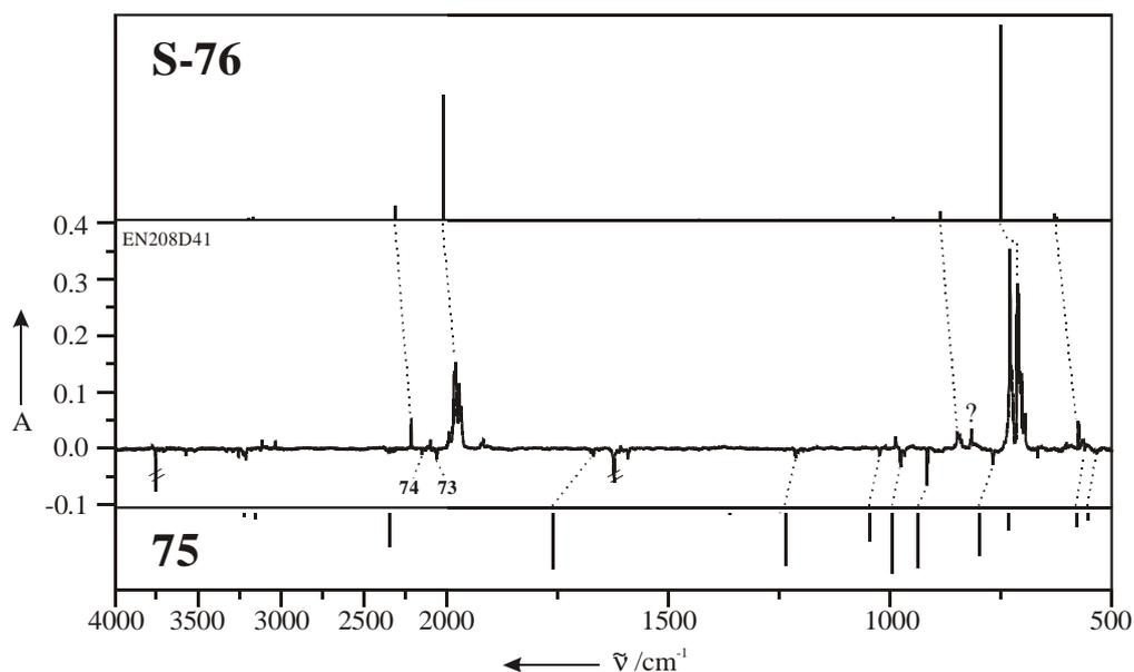
Abbildung 44: Vergleich des experimentellen (Argon, 10 K) Differenzspektrums (Produktbanden zeigen nach unten) der Bestrahlung von **S-76** mit  $\lambda > 310$  nm mit den berechneten (B3LYP/6-311+G(d,p)) IR-Spektren von (N-Methylylidene)iminoacetonitril (**S-76**) und 2-Cyan-2*H*-aziren (**75**).
