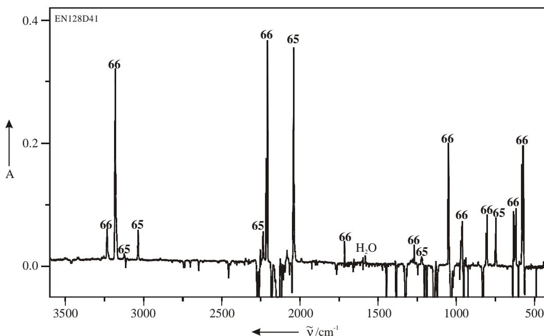
Abbildung 38: Experimentelles (Stickstoff, 10 K) Differenzspektrum nach 10 min Bestrahlung von **62** mit Licht der Wellenlänge  $\lambda = 313\text{ nm}$ .
