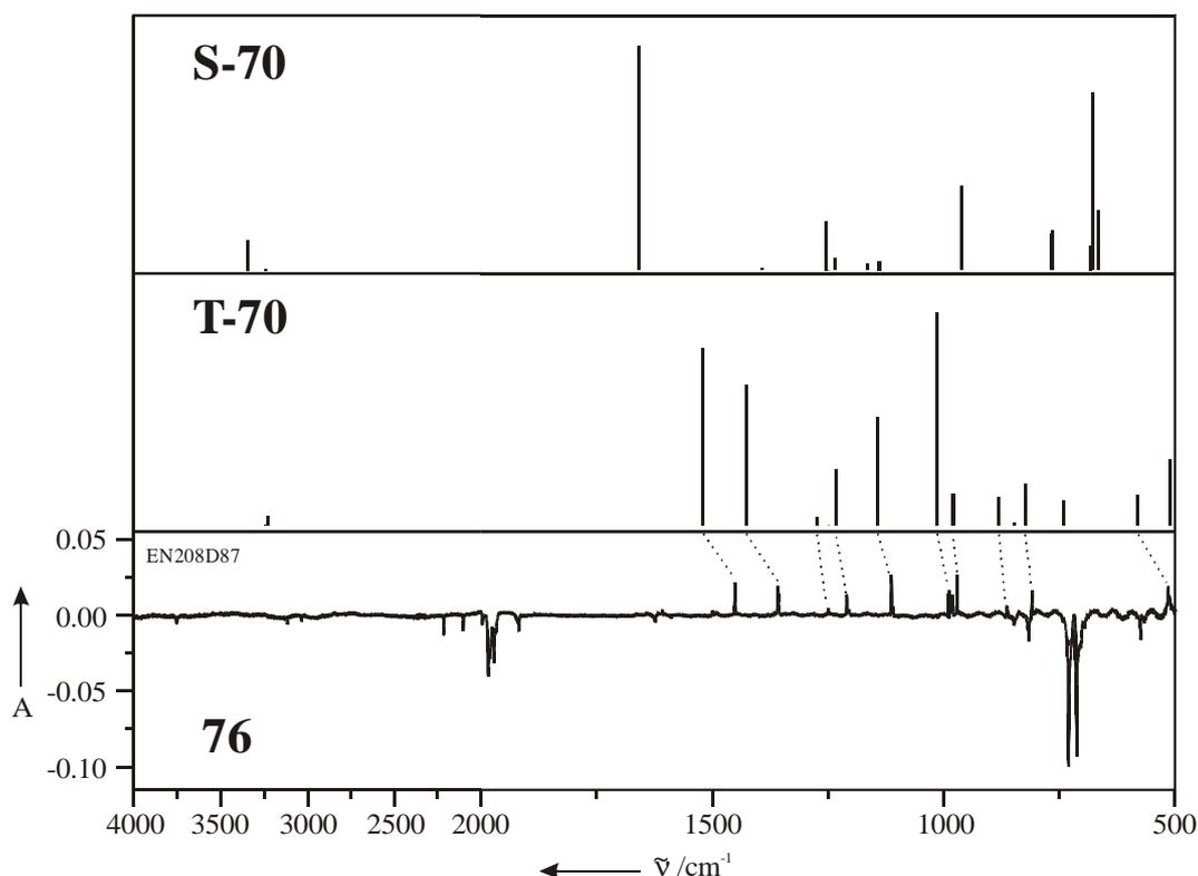
Abbildung 43: Vergleich des experimentellen (Argon, 10 K) Differenzspektrums (Produktbanden zeigen nach unten) nach der Bestrahlung von **T-70** mit  $\lambda > 570 \text{ nm}$  und Vergleich mit dem berechneten (B3LYP/6-311+G(d,p)) IR-Spektrum von **T-70** (Mitte) und **S-70** (oben).
