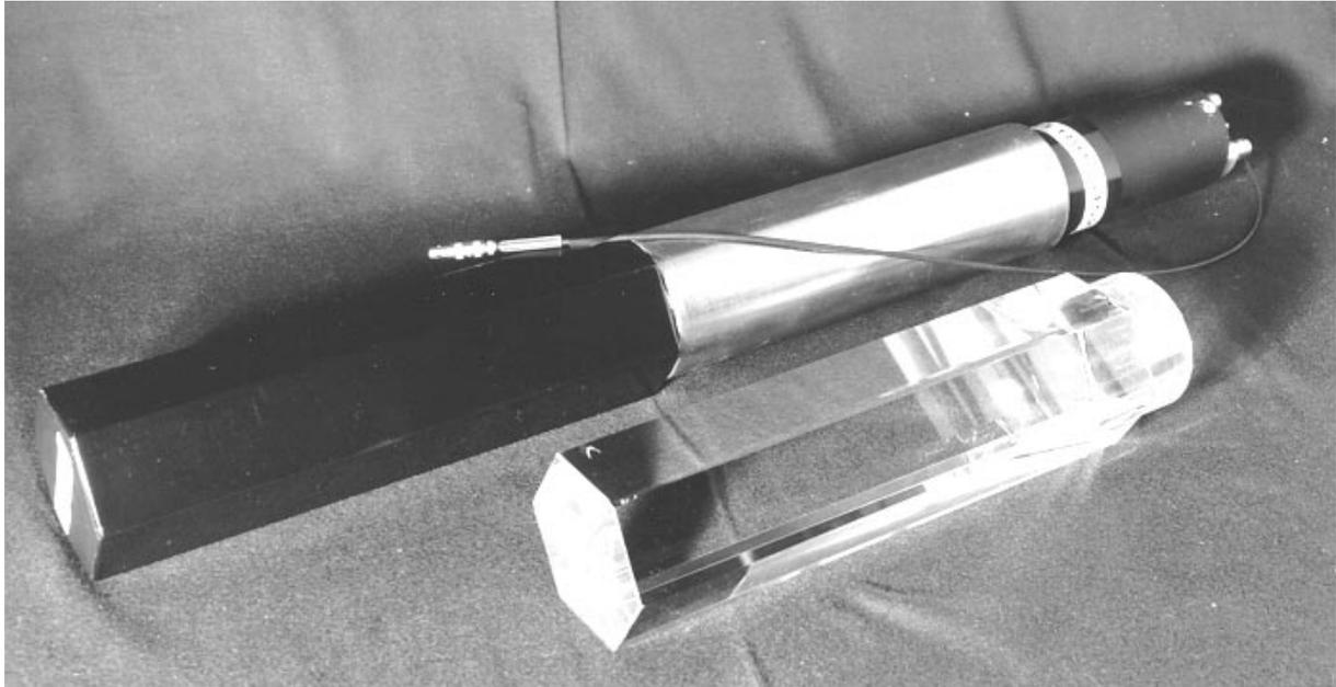
**Abbildung 5** Photo eines TAPS-Moduls. Im Vordergrund zu sehen, ein BaF<sub>2</sub>-Kristall, wie er im TAPS-Detektor zum Einsatz kommt.
