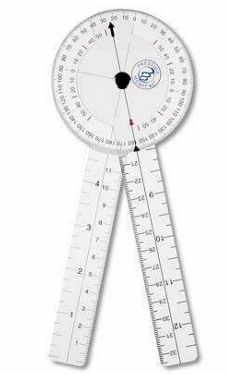
Abbildung 7: Goniometer zur Messung der Kopfwangshaltung
