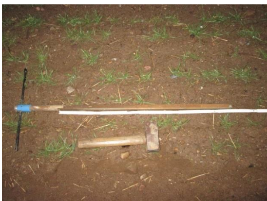
Photo 10: Bohrstock zur Bodenprobenentnahme in 0-90 cm Bodentiefe im Februar 2020 (Photo: Desaga 2020).
