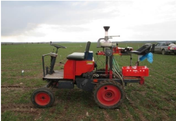
Photo 3: Parzellendüngerstreuer mit Bandkopf und pneumatischer Düngerverteilung bei der ersten N-Düngung im Weizen 2020 (Photo: Desaga 2020).
