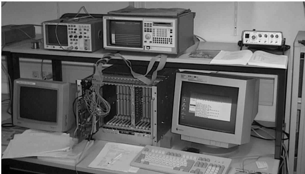
**Abbildung 20** : Testumgebung für die Hauptplatine des Spillmonitors mit VME-Crate, Oszilloskop und Logikanalysator.
