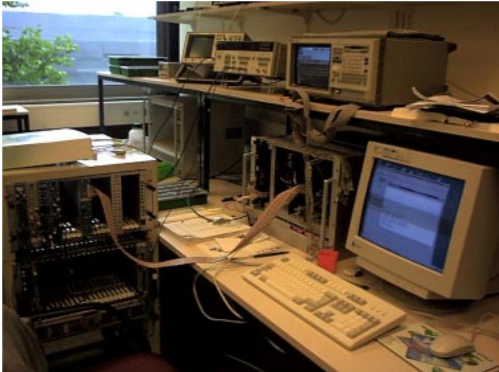
**Abbildung 26:** Testumgebung für die Inbetriebnahme der Aufsteckplatine : Oszilloskop, Pulsgenerator und Logik-Analysator befinden sich im oberen Teil des Bildes, links sind das NIM-Crate mit Konverter und das „twisted pair“ Kabel zu sehen.
