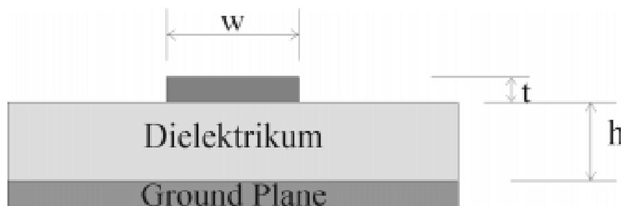
Abbildung 12 : Aufbau einer Microstrip Line
