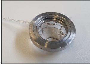
Abbildung 3.2.5: Für Calciummessungen verwendeter Metallring zur Applikation von Substanzen unter hypoxischen Bedingungen
