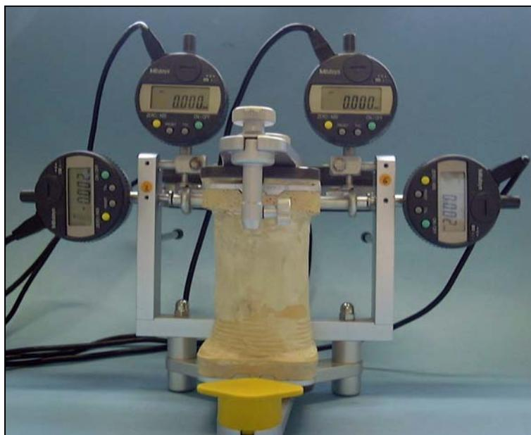
Abb. 2b: Messvorrichtung mit Gipschlüssel (Foto aufgenommen in der Abteilung für Prothetik des Zentrums für Zahn-, Mund- und Kieferheilkunde Gießen)
