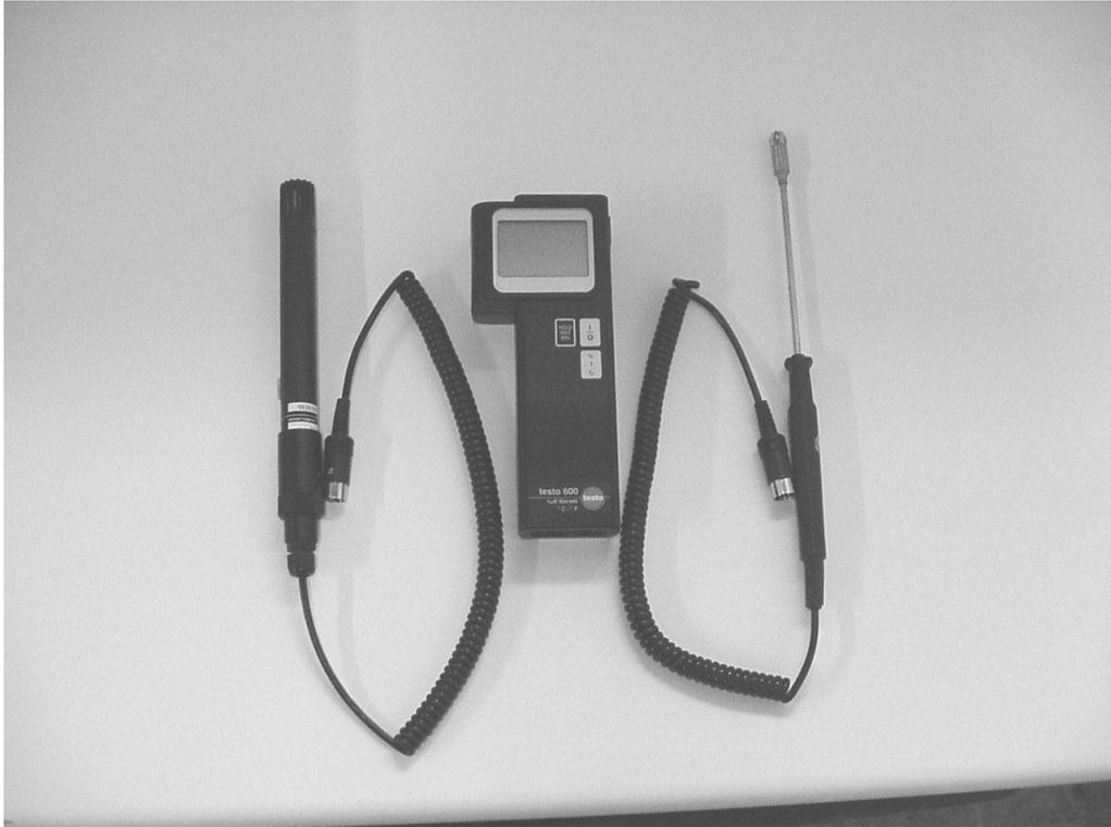
**Abbildung 9:** Meßgerät mit Kreuzfühler und Temperatur- /Luftfeuchte-Fühler für die Oberflächentemperatur, Stalllufttemperatur und die Luftfeuchtigkeit (Testo 400/452)
