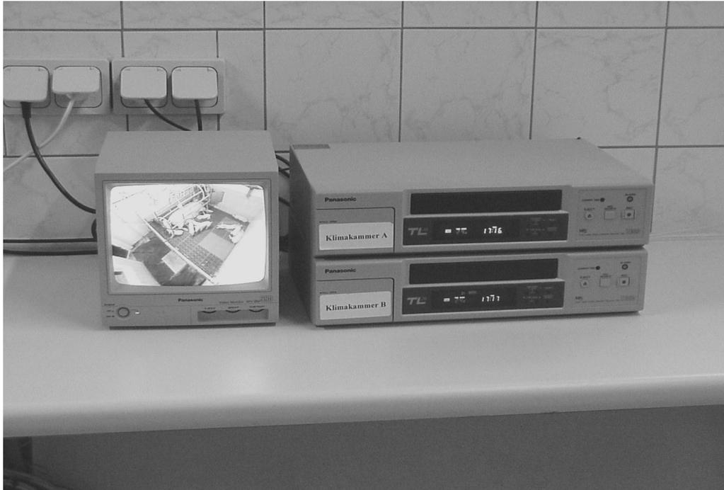
**Abbildung 6:** Langzeit-Videorecorder mit Überwachungsmonitor (WV-BM80)
