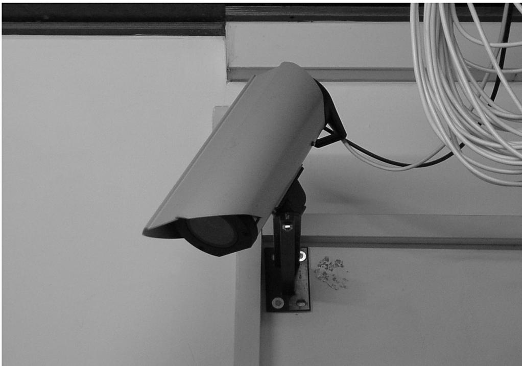
**Abbildung 5:** Infrarotvideokamera mit Weitwinkelobjektiv (WV-BP 500, Panasonic)
