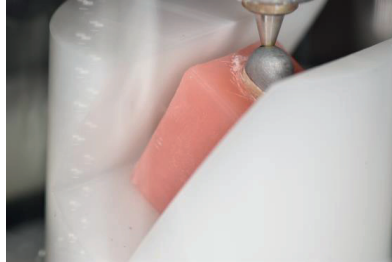
Abbildung 4.15: Zahn mit konventionell gegossenem Stiftaufbau in PMMA-Modell eingebettet und in Kausimulator eingespannt, Kontrolle der Positionierung anhand der Einkerbung am Stiftaufbau und der Antagonistenspitze.
