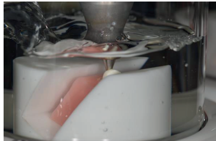
Abbildung 4.16: Zahn mit gefrästem Stiftaufbau in PMMA-Modell eingebettet unter thermozyklischer Wechsellast.
