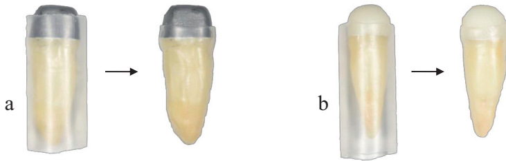
Abbildung 4.10: a) Extrahierter Zahn mit eingesetztem, konventionell gegossenem Stiftaufbau sowie Schrumpfschlauch vor und nach dem Erhitzen vor der Abtrennung auf Höhe der Schmelz-Zement-Grenze, b) Extrahierter Zahn mit eingesetztem, digital gefrästem Stiftaufbau sowie Schrumpfschlauch vor und nach dem Erhitzen vor der Abtrennung auf Höhe der Schmelz-Zement-Grenze.
