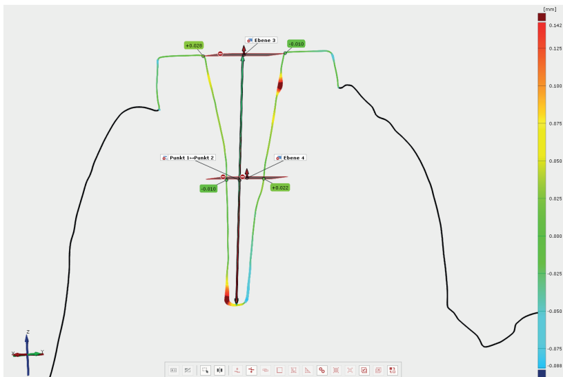
Abbildung 4.20: Inspektionsschnitt auf Ebene 2 (vestibulo-orale Ausrichtung) mit dargestellter Ebene 3 auf Höhe des Wurzelkanaleingangs und der dazu parallelen Ebene 4 auf der Hälfte der Aufbereitungslänge: Mithilfe des Flächenvergleichs wurden die Abweichungen an beiden koronalen und mittleren Punkten pro Ebene (Ebene 1 und Ebene 2) erhoben. Der Abstand zwischen Ebene 3 und dem apikalsten Punkt beschreibt die Aufbereitungslänge, wobei Rot den Wert für den CAD-Datensatz (Modell) und Grün den Wert für den Netz-Datensatz (direkte Digitalisierung) angibt.
