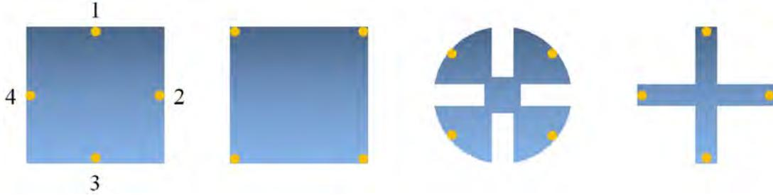
**Abbildung A.5.:** Unterschiedliche Kontaktanordnungen und Probengeometrien, die typischerweise für die Messungen des spezifischen Widerstandes nach der VAN-DER-PAUW-Methode bevorzugt werden, da sie gleichzeitig für die Durchführung von HALL-Effekt-Messungen geeignet sind.
