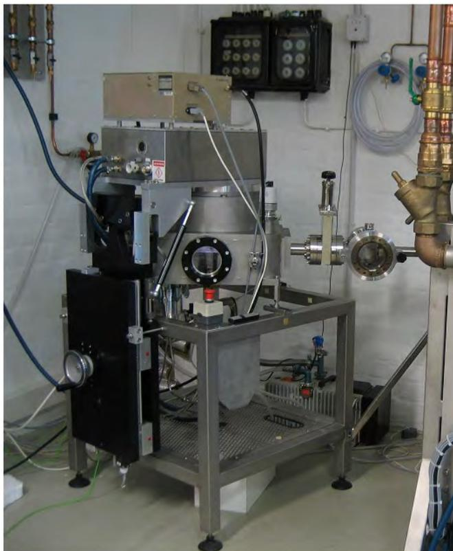
**Abbildung 3.4.:** Zur Herstellung von Aluminium-dotierten  $ZnO_{1-x}S_x$ -Dünnschichten verwendete MINI-RF-Kathodenzerstäubungsanlage.
