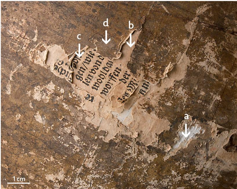
Abb. 8 Schichtaufbau des Erdglobus (Ausschnitt): Gipsgrundierung (a), Makulaturpapiere (b–c) und Papier mit Globuskarte (d).
