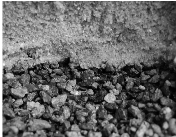
Abbildung 5.3: Grenzfläche der Natur-/Recyclingmaterialkombination N-KS-0/2 mit R-KB-Q-2/10 nach 5-stündiger Durchströmung
