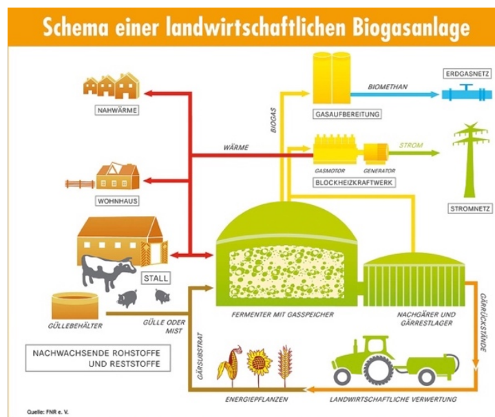
Abbildung 19: Schema einer landwirtschaftlichen Biogasanlage Quelle: Fachagentur Nachwachsende Rohstoffe e.V. (FNR) (2011)
