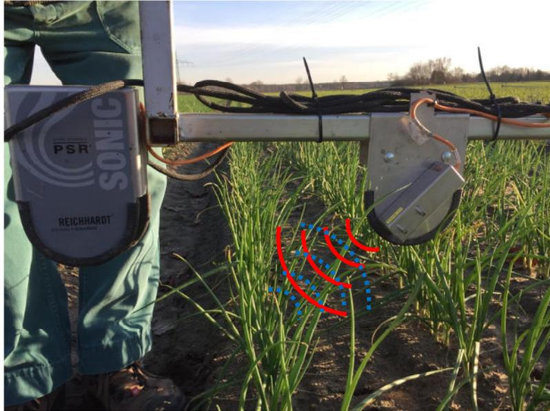
**Abb. 7:** Funktionsweise der SONIC Einheit von REICHHARDT schematisch dargestellt auf einem Zwiebelfeld
