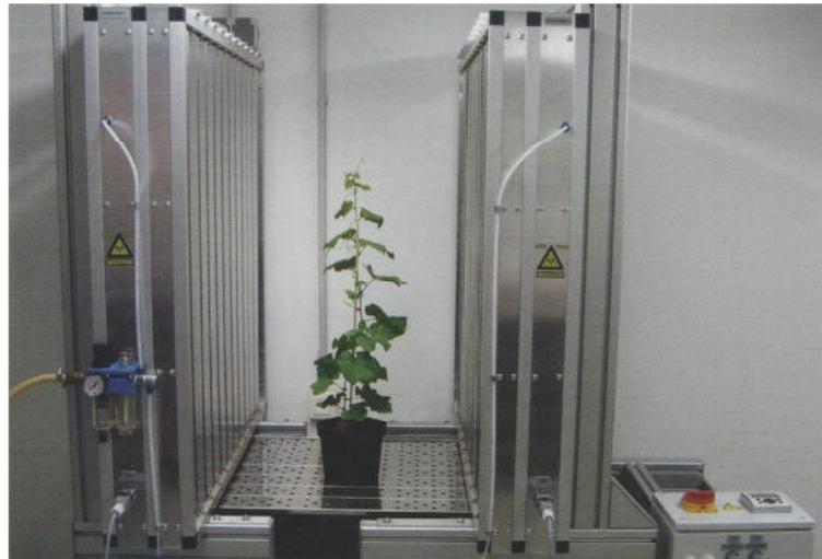
**Abb. 67:** UV-C Gewächshausmodul zur Bestrahlung von Topfreben;
