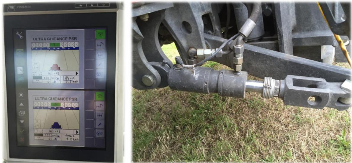
**Abb. 41:** Detailansicht des Touchterminals mit split screen Darstellung (links), zur Bedienung des neuen Zylinders (Detailansicht rechts)
