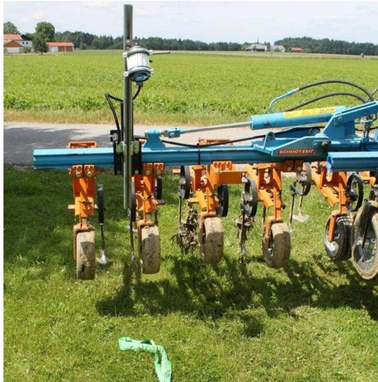
**Abb. 5:** Abtastung einer Kulturreihenattrappe auf einer Wiese mit einer Kamera der Firma SCHMOTZER; Quelle: SCHMOTZER (2015b)
