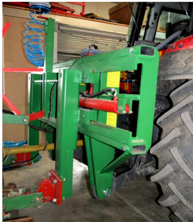
**Abb. 11:** Verschieberahmen G 4000 H von WAGNER, angebaut an einen Traktor;
