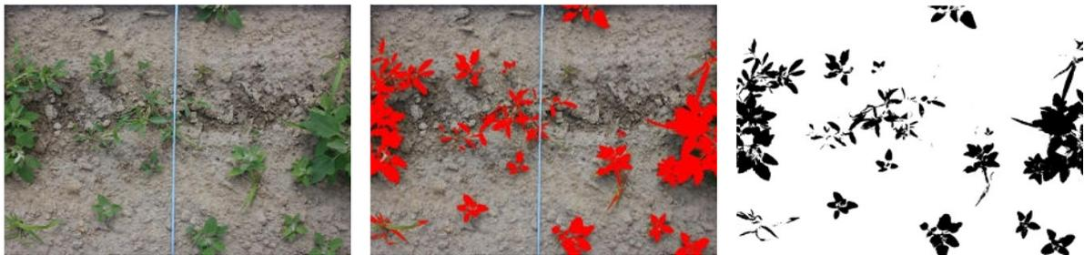
**Abb. 33:** Momentaufnahmen der Bildanalyse von links: Original; Rotfärbung der grünen Pixel; Transformation der Aufnahme in schwarz-weiß
