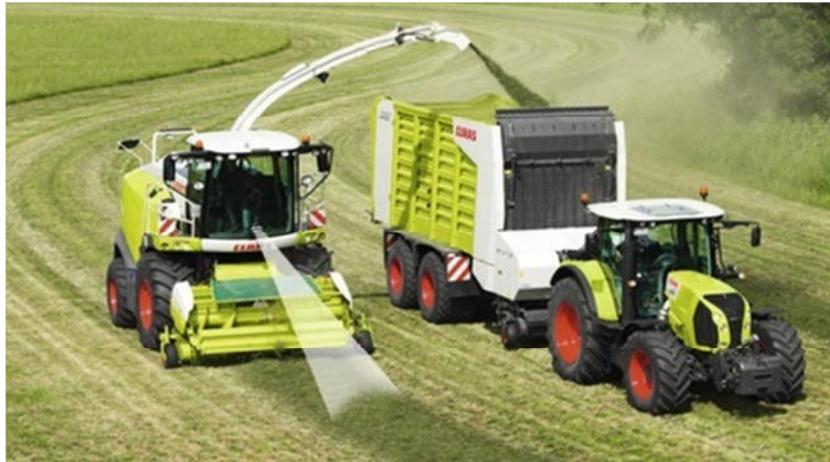
**Abb. 4:** CAM Pilot zur Steuerung eines selbstfahrenden Feldhäckslers, hier entlang eines Heuschwades; Quelle: CLAAS (2016)
