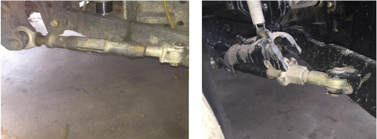
**Abb. 27:** Manuelle (links) und automatische (rechts) Seitenstrebe eingebaut in einen Traktor
