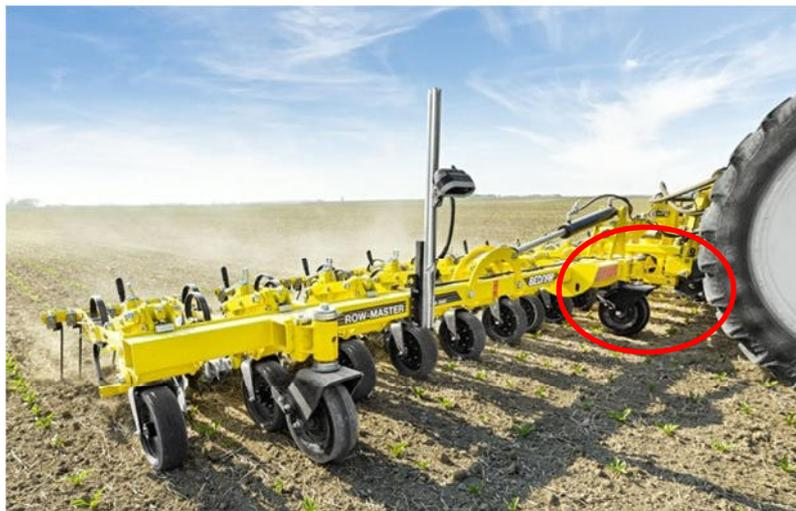
**Abb. 8:** Darstellung der Parallelogrammverschiebung (rote Kennzeichnung) der Firma BEDNAR fest mit einer Hacke verbunden; modifiziert nach BEDNAR (2016)
