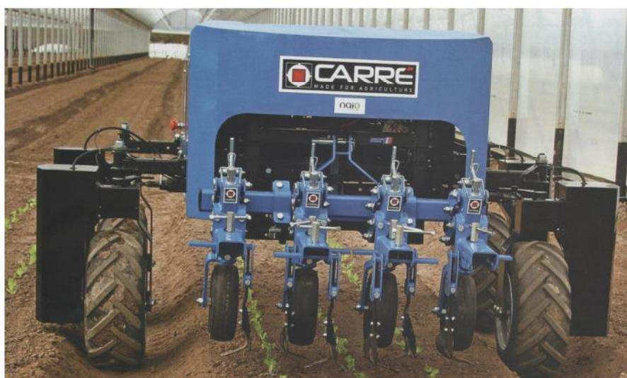
**Abb. 22:** Hackroboter CARRÉ ANATIS in beim Einsatz in einer Reihenkultur;
