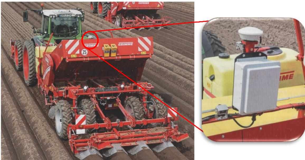
**Abb. 12:** Kartoffellegegerät mit GPS-Ausrüstung der Firma TRIMBLE® (rote Kennzeichnung links), sowie Detailaufnahme der Antenne und des Navigationsrechners (rechts); modifiziert nach SCHULZ (2015)
