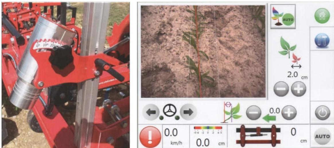
**Abb. 6:** IC Light Kamera der Firma STEKETEE angebaut an eine Hacke (links) und Ausschnitt der Bedienoberfläche (rechts); Quelle: STEKETEE (2015)
