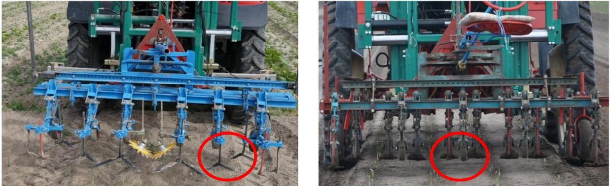
**Abb. 30:** Heckansicht der RUSTICA Hacke ausgerüstet mit Flachhackschar (rote Kennzeichnung links) und Gänsefußschar (rote Kennzeichnung rechts)
