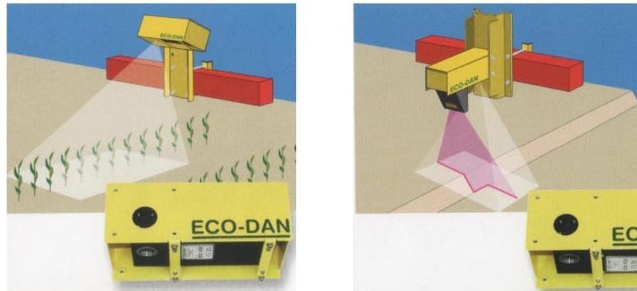
**Abb. 2:** Schema der Bestands-(links) und Furchenabastung (rechts) mit einer Kamera der Firma ECO-DAN; Quelle: ECO-DAN (2013)
