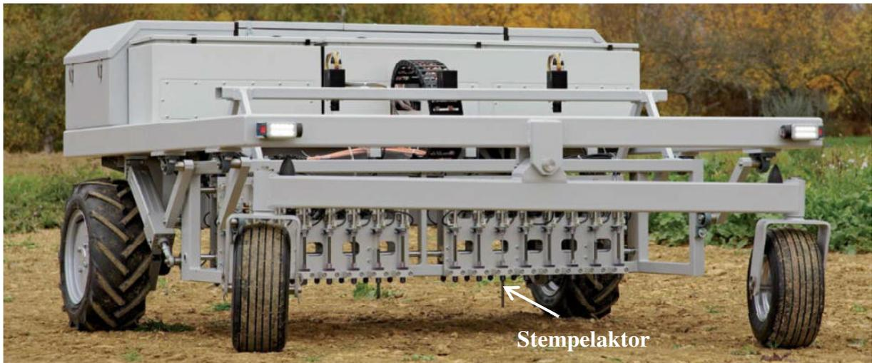
**Abb. 21:** Deepfield Weeding-Roboter ausgerüstet mit Stempelaktor (weiße Kennzeichnung);
