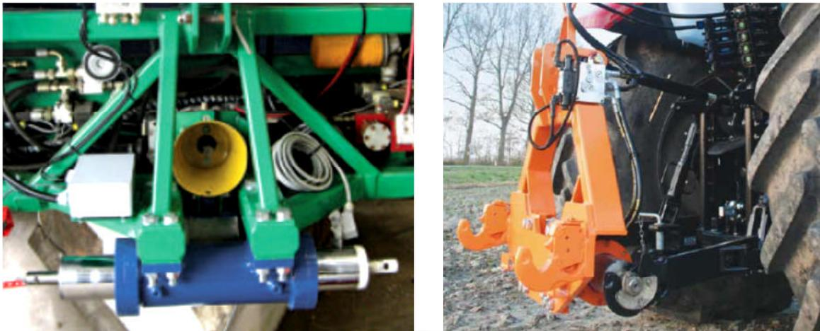
**Abb. 15:** Side-Shift-Anhängebock fest an einem Gerät verbaut (links) bzw. als Verschieberahmen an einen Traktor angebaut (rechts); Quelle: SBG (2015)
