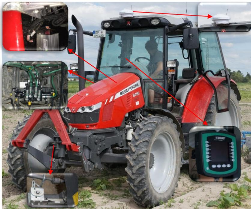
**Abb. 26:** Detailansichten und Lokalisation wichtiger Komponenten einer GPS Lenkautomatik eingebaut in einen Traktor
