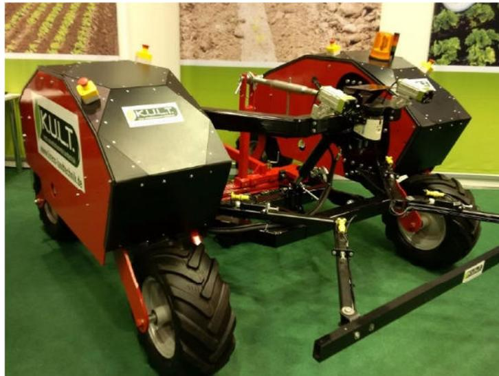
**Abb. 23:** Frontansicht des autonomen Geräteträger UWE;
