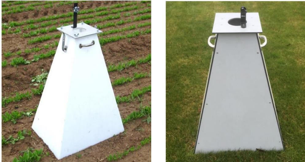
**Abb. 32:** Weißer (links) und grauer (rechts) Stativtrichter zur Fotografie der Referenzparzellen auf den Untersuchungsfeldern
