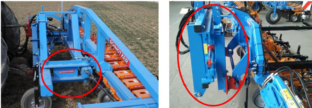
**Abb. 10:** Parallelogramm- (Typ AV5; rote Kennzeichnung links) und Parallelverschiebung (Typ PVR; rote Kennzeichnung rechts) von Schmotzer, jeweils angebaut an einer Hacke; Quelle: SCHMOTZER (2015)
