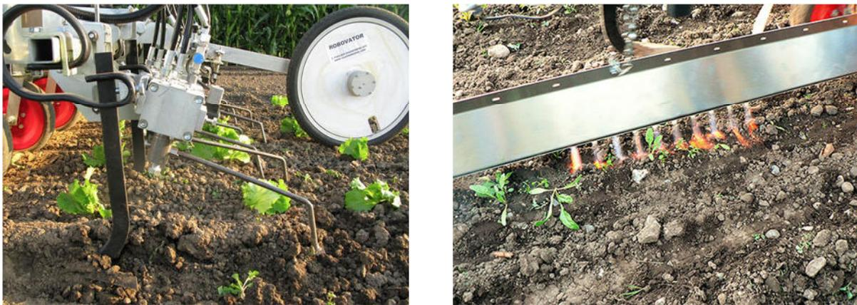
**Abb. 20:** Das mechanische Jätewerkzeug (links) und die thermische Abflammschiene (rechts) des ROBOVATORS während der Segetalpflanzenregulation auf einem Salatfeld;
