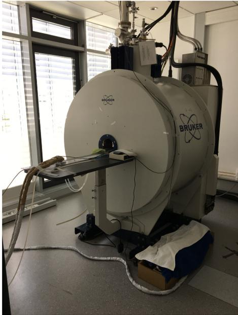
Abb.12: 7T-Magnetresonanztomographie des Max-Planck-Institut in Bad Nauheim, DE.
