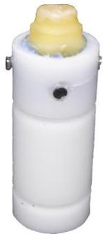
Abb. 4.5: CNC-gefräster, standardisierter Zahnstumpf in Halterung
