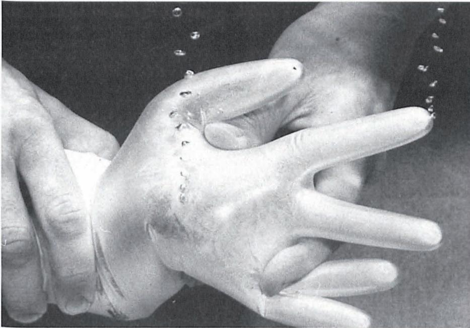
Abb. 2: Vinylhandschuh bei der Unterwasserprüfung.
