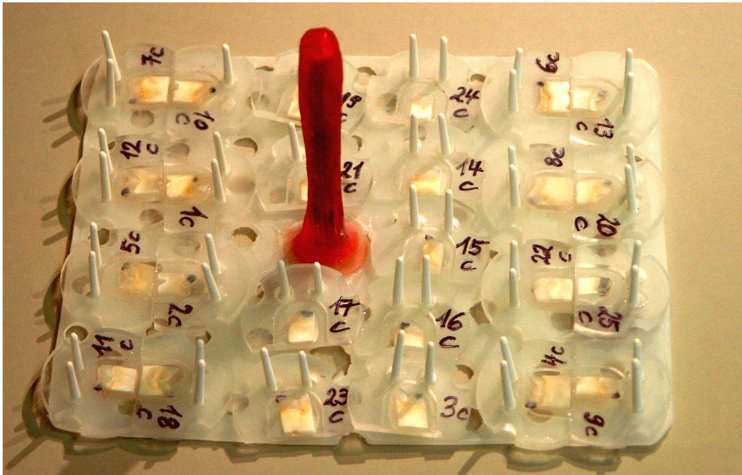
Abb 8 Plastikträger mit in Probenhalter für die Mikroradiografie eingeklebten Zahnproben. Mit dieser Vorrichtung war gewährleistet, dass alle Proben gleichmäßig den Versuchslösungen ausgesetzt waren
