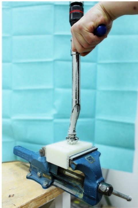
Abbildung 8: Präparation des Kunstknochenschaums mit hemisphärischen Fräsen.
