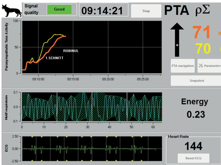
**Abbildung 20:** Dargestellt ist das falsch hohe Auszählen der Herzfrequenz, da die T-Wellen zusätzlich als QRS-Komplex gezählt werden im Expert-Mode. Daraus ergibt sich eine vermeintliche Tachykardie.
