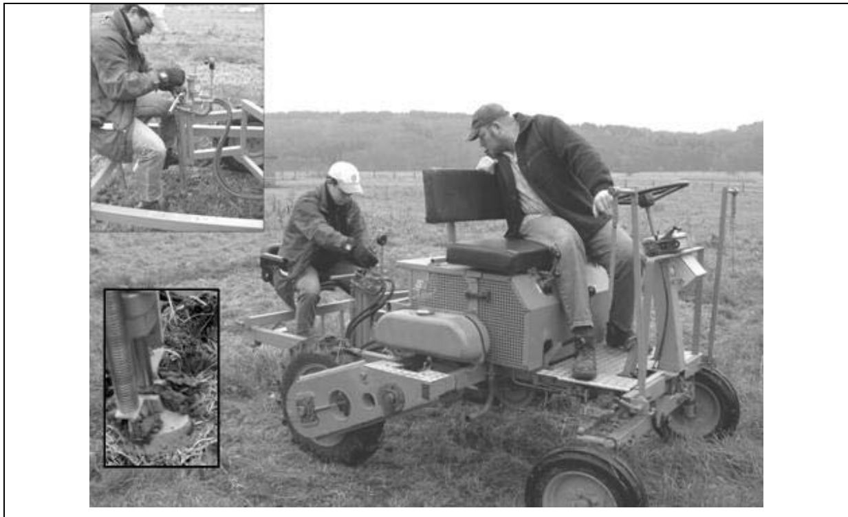
Abb. 14: Versuchsgeräteträger „Hege 75“ mit angebauter hydraulischer Rinderklaue.
