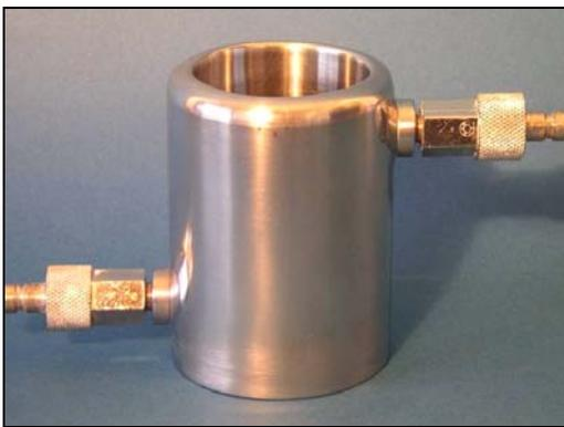
Abbildung 4-11: Doppelwandiger Mahlbecher mit Wasseranschlüssen zum Kühlen
