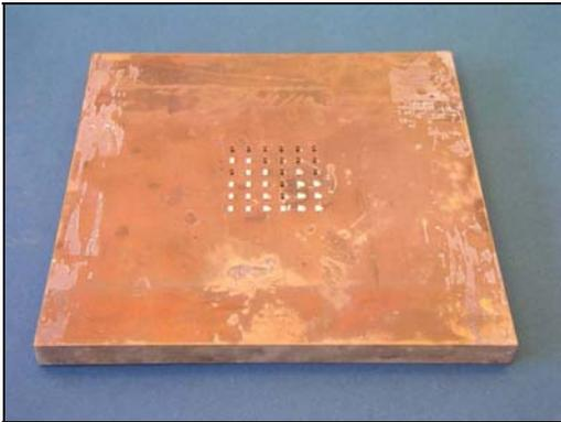
**Abbildung 4-17: Vorrichtung zur Fixierung von Substraten**
