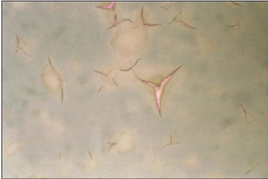
**Abbildung 5-13: Rissbildung auf Siliziumwavern bei der Verwendung von wässrigen Solen, aufgenommen mit einem Lichtmikroskop bei 200facher Vergrößerung.**
