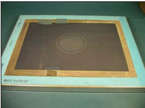
**Abbildung 4-18: Sieb im Spanrahmen**
