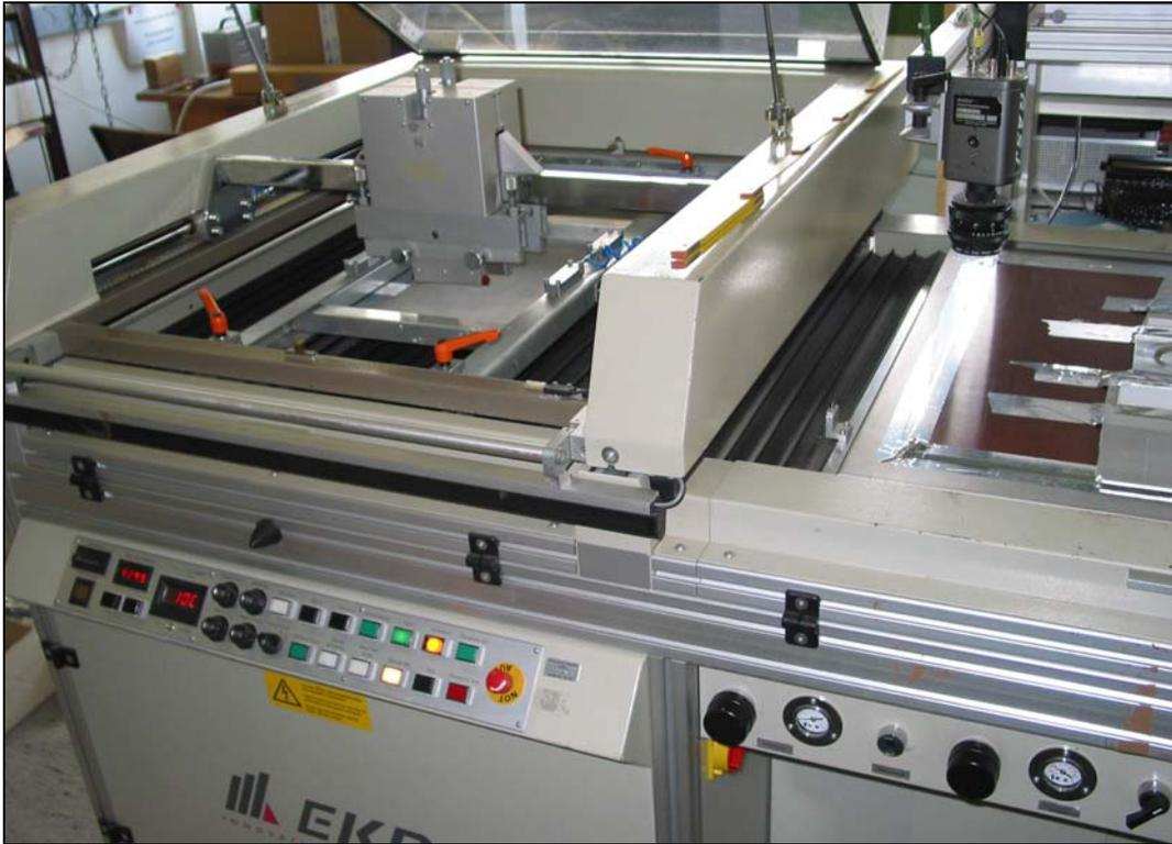
**Abbildung 4-15:** Drucker der Firma EKRA Typ S50. Links zu sehen ist der Drucktisch mit Flut- und Druckkrakel, Spannrahmen und hierin eingespanntem Sieb. Rechts ist die Aufnahme für den Substrathalter und die Kameras zur optischen Justierung der Platte.
