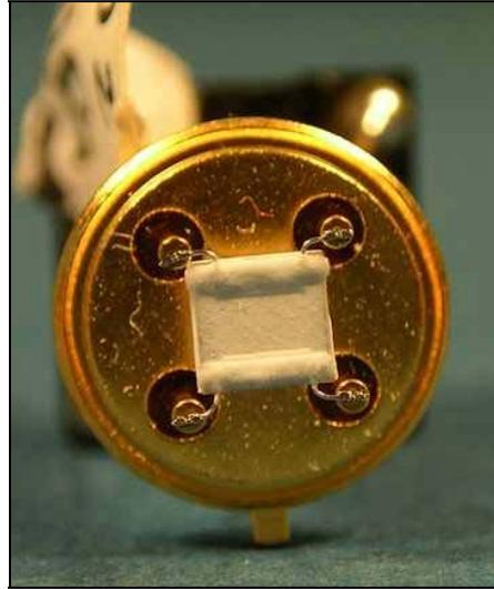
**Abbildung 5-16: UST-Substrat, präpariert mit organischem Sol**
