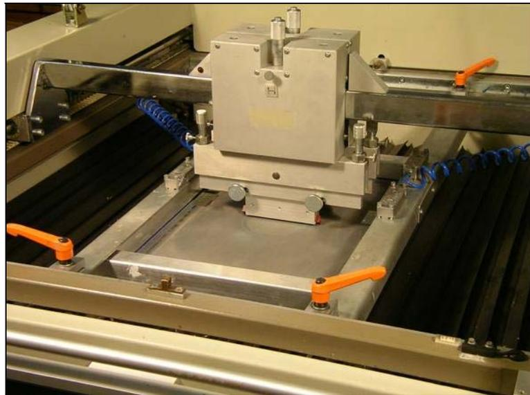
**Abbildung 4-16:** Detailaufnahme Sieb mit Druckkrakel im Halbautomaten
