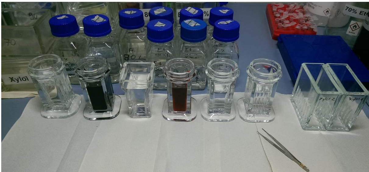
Abbildung 2-6: Aufbau der HE-Färbung. Gezeigt werden die Gefäße mit den für die HE-Färbung benötigten Reagenzien in der Reihenfolge des verwendeten Färbeprotokolls.
