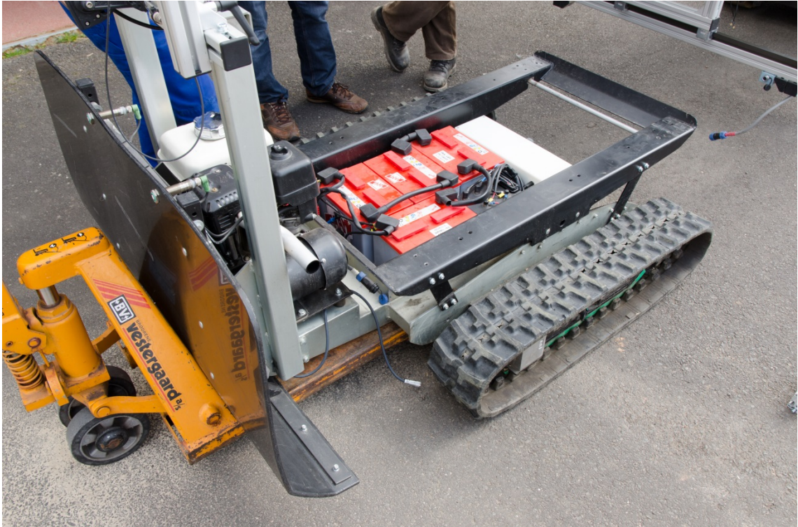
Abb. 55 Demontage des Kameralagerungsregelungssystems; Anheben und Herausfahren mit Hubwagen
