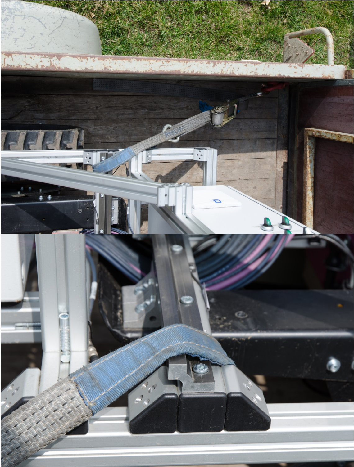
Abb. 49 Abspannen des PHENObot auf Anhänger
