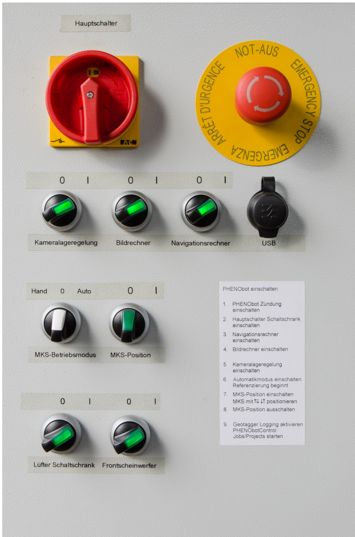
Abb. 9 Schalterfeld I, seitlich am Schaltschrank; Schalterstellung für Automatikbetrieb
