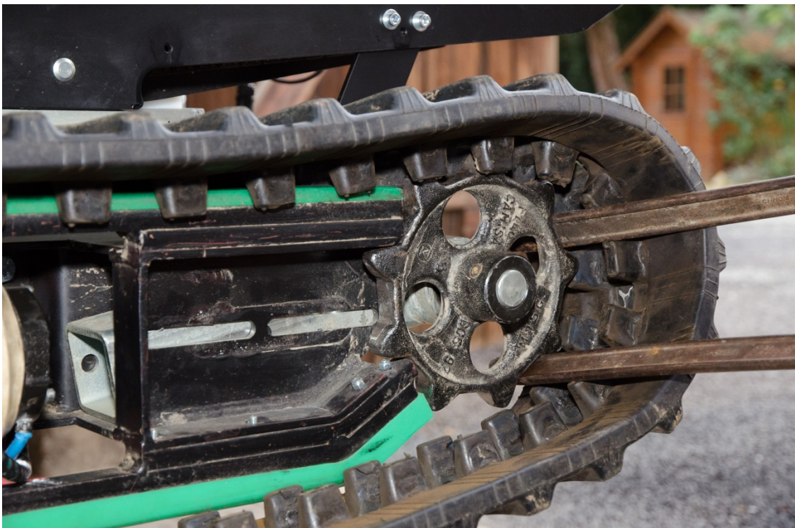
Abb. 60 Abhebeln der Kette
