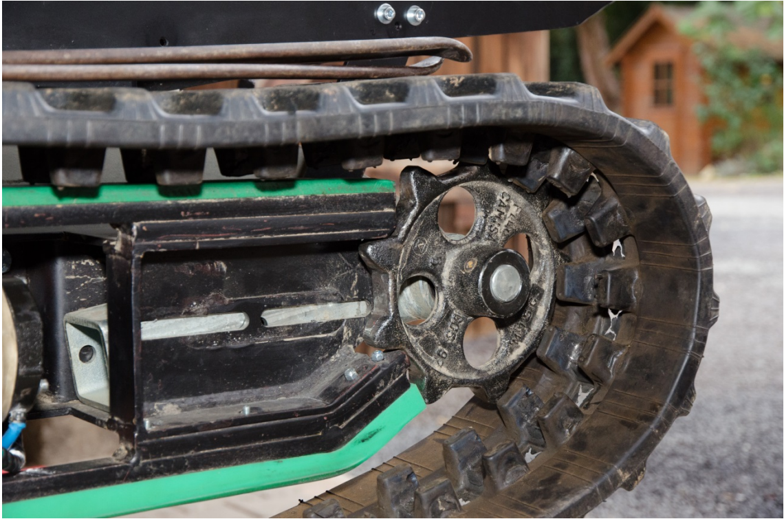
Abb. 63 Kette ist vom Sternrad runtergesprungen und kann komplett abgenommen werden
