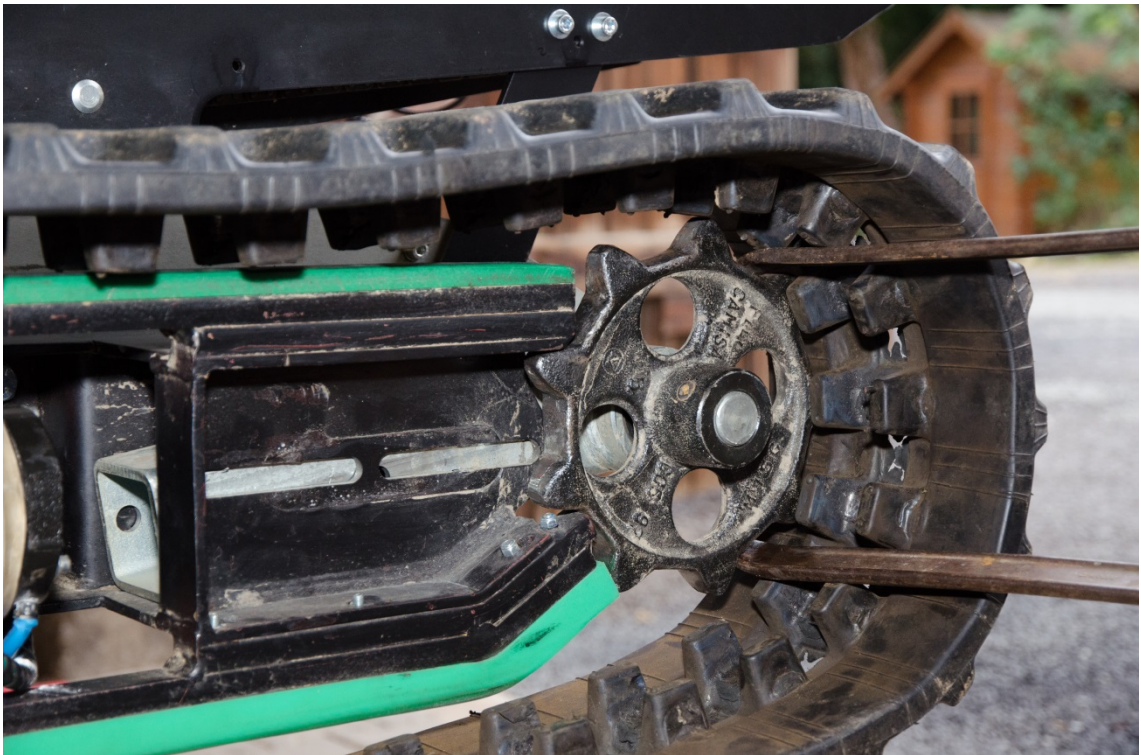
Abb. 62 Abhebeln der Kette
