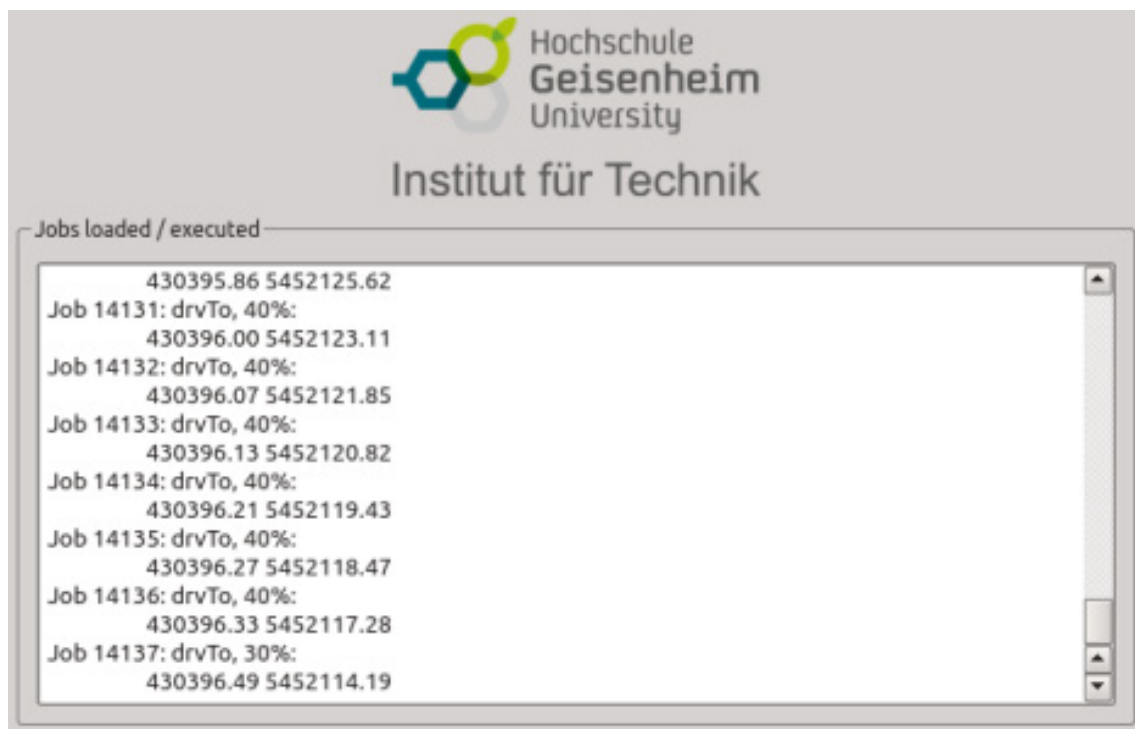
Abb. 14 Aufgabenplaner während der Ausführung wird die sequentielle Abarbeitung Schritt für Schritt dargestellt.
