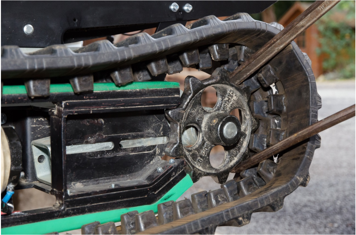
Abb. 61 Abhebeln der Kette
