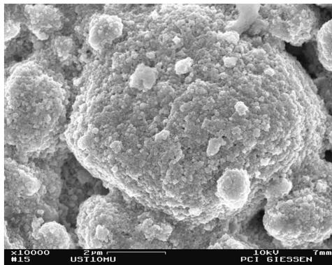
**Abbildung 4.33.:** REM-Aufnahme des Sensors UST10MU. Es sind Ansammlungen (ca.  $3 \mu\text{m}$  Durchmesser) zu erkennen, deren Oberfläche von 50 nm großen Körnern bedeckt sind. Vergrößerung:  $\times 10.000$
