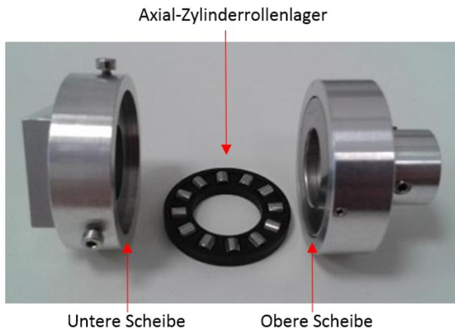
Abbildung 7: Aufsätze für das pin-on-disk Tribometer, die es ermöglichen, Rollreibung zu erzeugen. Oben und unten befindet sich jeweils eine Scheibe mit einem Außendurchmesser von 28 mm, einem Innendurchmesser von 15 mm und einer Dicke von 2 mm. Dazwischen liegt ein Zylinderkäfig, in dem die Zylinder frei drehbar sind. Wenn die obere Scheibe gedreht wird, rollen die Zylinder zwischen den beiden Scheiben und verursachen dadurch Rollreibung.
