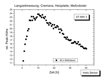
Abb. 3.59: Verlauf der relativen Peakhöhe des ST-MW3 bis zu hohem Fettalter (44 h, FOS ca. 4). Die Messung wurde am automatischen Meßplatz durchgeführt. Meßintervall ca. 30 min
