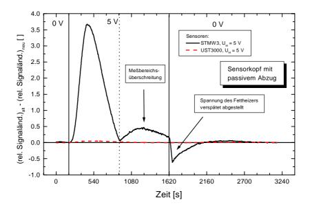
Abb. 3.90: Differenz der relativen Signaländerung von altem und frischem Fett für die Sensoren ST-MW3 und GGS 3000
