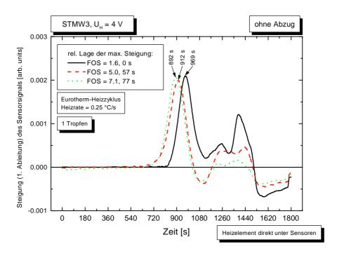
Abb. 3.93: Abhängigkeit der Lage des Maximums der 1. Ableitung (Wendepunkt) vom Fettalter für den ST-MW3
