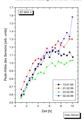
Abb. 3.53: Verlauf der absoluten Peakhöhen des ST-MW3 bei 2 Minuten Meßdauer für 4 unabhängige Messungen an dem Fritierfett Cremana
