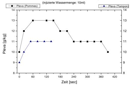
Abb. 3.46: Feuchteverlauf nach Fritieren von 200 g Pommes frites. Im Vergleich zum Verlauf beim Fritieren eines Tampons
