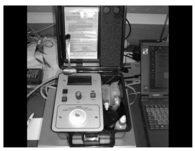
Abb. 2.4: Foodoil – Sensor. Man erkennt im unteren Bereich der Abb. den Napf, in welchen das zu messende Fett mit dem ebenfalls dargestellten Löffel eingefüllt wird. Der Abgleich des Nullpunktes erfolgt mit dem Nullöl des Herstellers (Fläschchen unten rechts)
