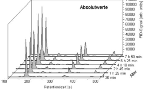
Abb. 3.7: Alterungsreihe von Sonnenblumenöl, dargestellt als 3-d-Diagramm für die Retentionszeit  $t_R = 100 \text{ s}$  bis 500 s (gealtert nach der Prozedur 3)
