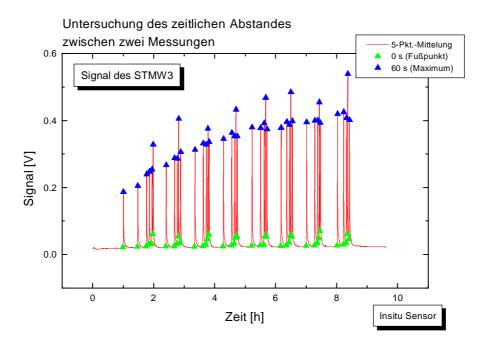
Abb. 3.75: Meßsignale des ST-MW3 bei der Untersuchung des zeitlichen Abstands zwischen zwei Messungen. Man erkennt deutlich die "Ausreißer", die auf Abweichungen von der Solltemperatur zurückgehen
