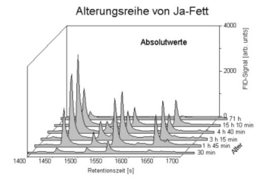
Abb. 3.13: Alterungsreihe von Fett der Marke Ja, dargestellt als 3D-Diagramm für die Retentionszeit  $t_R = 1400 \text{ s}$  bis 1700 s (gealtert nach der Prozedur 1)
