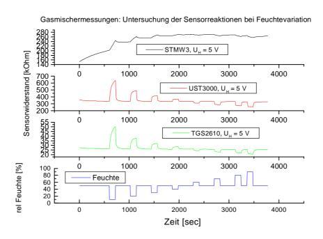
Abb. 3.97: Ansprechverhalten der Gassensoren auf Feuchtevariation am Gasmischer
