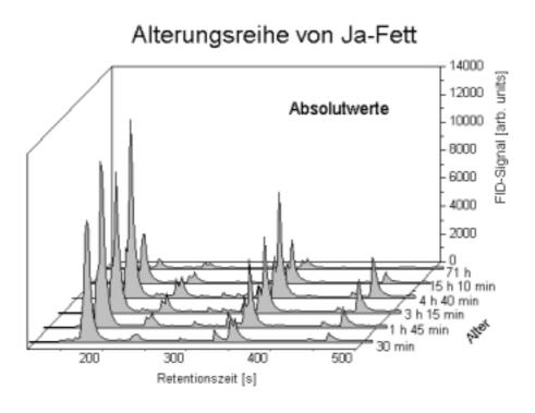
Abb. 3.10: Alterungsreihe von Fett der Marke Ja, dargestellt als 3-d-Diagramm für die Retentionszeit  $t_R = 100$  s bis 500 s (gealtert nach der Prozedur 1)
