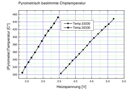
Abb. 3.1: Zusammenhang zwischen Heizspannung U<sub>H</sub> und der Substrattemperatur für den GGS 3330 und den GGS 3530 T (Low – Power)
