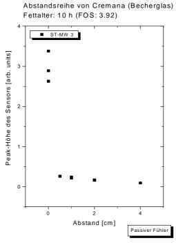
Abb. 3.69: Abhängigkeit der Peakhöhe des ST-MW3 vom Abstand des Insitu – Sensors von der Fettoberfläche
