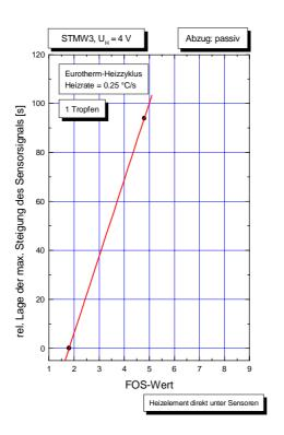
Abb. 3.94: Relative Lage des Steigungsmaximums in Abhängigkeit vom FOS-Wert; Abzug: passiv
