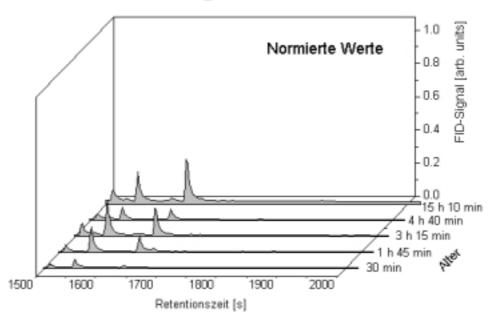
Abb. 3.17: Alterungsreihe von Fett der Marke Ja, dargestellt als 3D-Diagramm für die Retentionszeit  $t_R = 1500 \text{ s}$  bis 2000 s (gealtert nach der Prozedur 1)
