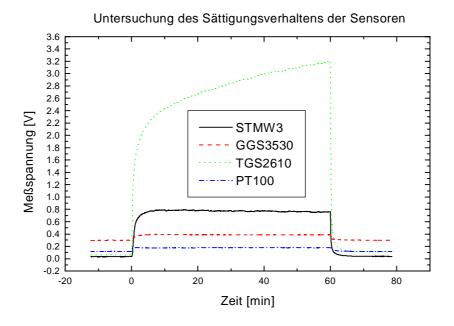
Abb. 3.80: Verlauf der Sensorsignale bei einer Verweildauer des Insitu – Sensors von einer Stunde über dem 180 °C heißen Fritierfett
