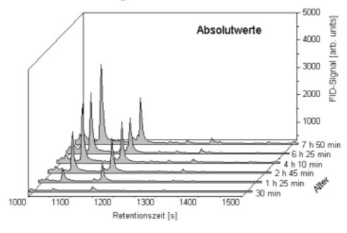
Abb. 3.9: Alterungsreihe von Sonnenblumenöl, dargestellt als 3-d-Diagramm für die Retentionszeit  $t_R = 1000 \text{ s}$  bis 1500 s (gealtert nach der Prozedur 3)
