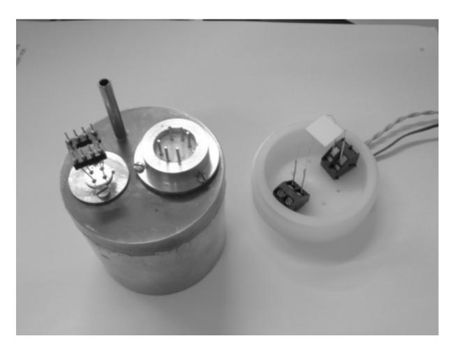
Abb. 2.16: Links: Messinggehäuse des Exsitu – Sensors mit Abzugsröhrchen und den Sensoren ST-MW3 und GGS 3000 Rechts: Bodenstück mit Heizelement
