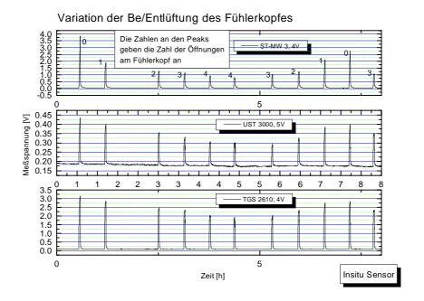
Abb. 3.70: Abhängigkeit der Sensorsignale von der Anzahl der offenen Belüftungslöcher
