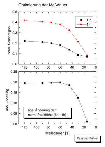
Abb. 3.73: Normiertes Sensorsignal des ST-Mw3 in Abhängigkeit von der Meßdauer für einen Peak bei einer Stunde und 6 Stunden Fettalterungsdauer
