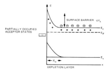
Abb. 1.13: Verarmungsrandschicht freier Ladungsträger an der Oberfläche eines nleitenden Halbleiters. Elektronen aus dem Leitungsband werden von Oberflächenzuständen eingefangen und führen zu einer negativ geladenen Oberfläche. Dadurch entsteht eine Doppelladungsschicht, die sich in einer Bandverbiegung äußert. [Boc 97]
