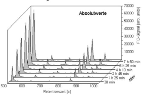
Abb. 3.8: Alterungsreihe von Sonnenblumenöl, dargestellt als 3-d-Diagramm für die Retentionszeit  $t_R = 500 \text{ s}$  bis 1000 s (gealtert nach der Prozedur 3)
