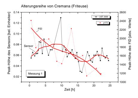
Abb. 3.37: Korrelation der absoluten Peakhöhe des GGS 3000 mit dem absoluten Peakhöhensignal des FID bei  $t_R=172~\mathrm{s}$
