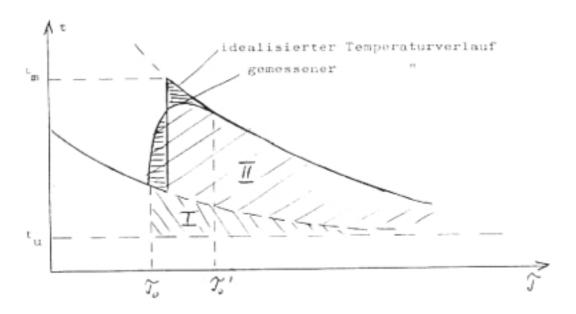
Abb. 1.5: Realer und idealisierter Temperaturverlauf des Kalorimeter - Inhalts
