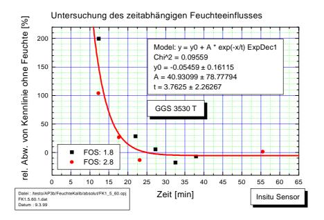
Abb. 3.62: Relative Abweichung von der Kennlinie ohne Feuchte in Abhängigkeit von der Zeit nach dem Fritieren für den GGS 3530 (Low – Power)
