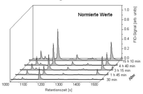
Abb. 3.16: Alterungsreihe von Fett der Marke Ja, dargestellt als 3D-Diagramm für die Retentionszeit  $t_R = 1000 \text{ s}$  bis 1500 s (gealtert nach der Prozedur 1)
