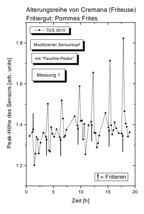
Abb. 3.44: Verlauf der absoluten Peakhöhe des TGS 2610
