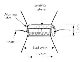
Abb. 2.20: Sensorelement des ST-MW 3 der Firma FIS [Fis] (Skizze)
