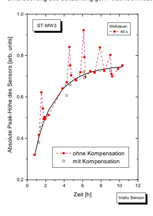
Abb. 3.65: Verlauf der absoluten Peakhöhen des ST-MW3 vor und nach der Feuchtekompensation
