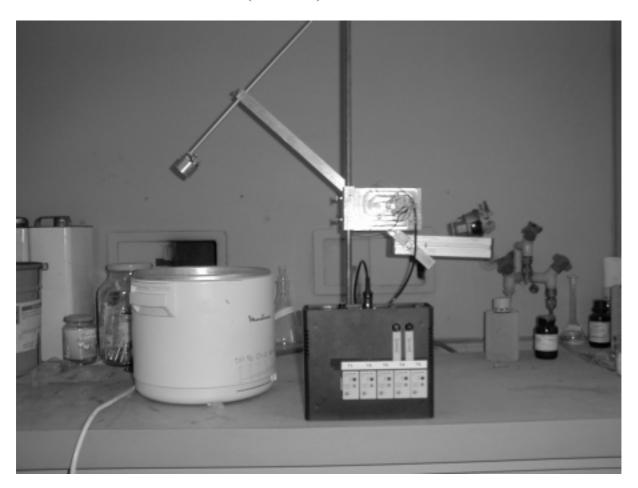
Abb. 2.17: Meßroboter mit Ansteuerelektonik, Insitu – Fühler und Friteuse
