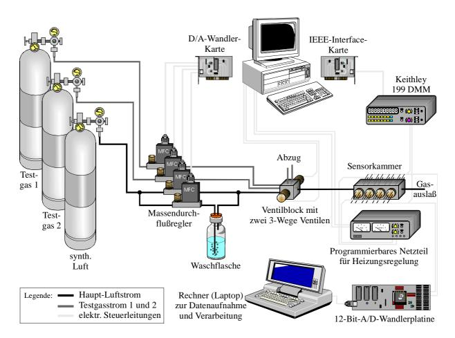
Abb. 2.6: Schematische Darstellung der Gasmischanlage
