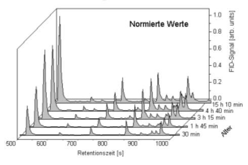
Abb. 3.15: Alterungsreihe von Fett der Marke Ja, dargestellt als 3D-Diagramm für die Retentionszeit  $t_R = 500$  s bis 1000 s (gealtert nach der Prozedur 1)
