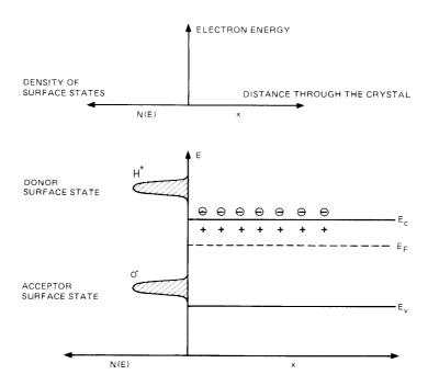
Abb. 1.12: Ausbildung von Bändern mit Oberflächenzuständen bei einem n-leitenden Halbleiter. Zur Vereinfachung sind die Bänder der Oberfächenzustände durch ein einzelnes Energieniveau dargestellt. [Boc 97]
