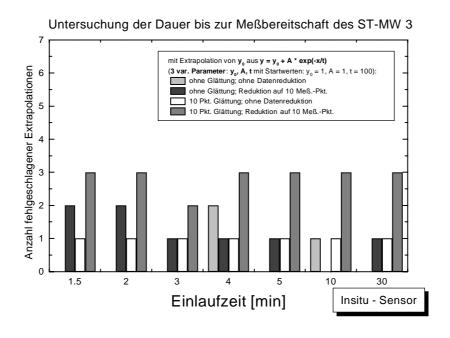
Abb. 3.85: Fehlerhäufigkeit bei der Extrapolation mit drei variablen Parametern bei Datenglättung und Datenreduktion
