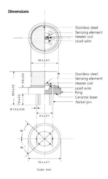
Abb. 2.23: Abmessungen des ST-MW3
