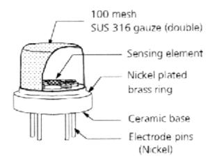
Abb. 2.22: Metallgehäuse des ST-MW3 [Fis]
