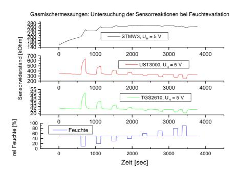
Abb. 3.99: Ansprechverhalten der Gassensoren auf Feuchtevariation am Gasmischer
