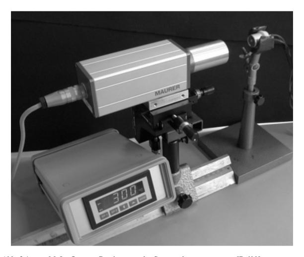
Abb. 2.1: Meßaufbau zur Bestimmung der Sensorsubstrattemperatur [Rei99]
