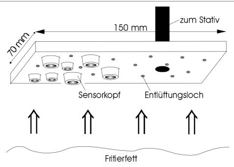
Abb. 2.11: Schematische Darstellung der Grundplatte des Sensorkopfes
