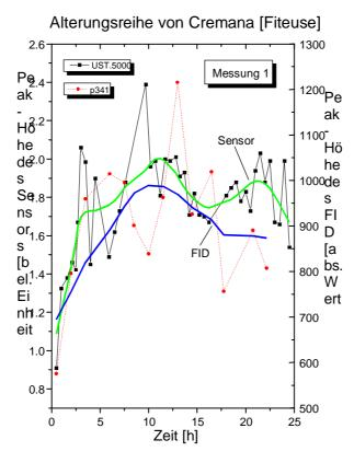
Abb. 3.35: Korrelation der absoluten Peakhöhe des GGS 5000 mit dem absoluten Peakhöhensignal des FID bei  $t_{\rm R}=341~{\rm s}$
