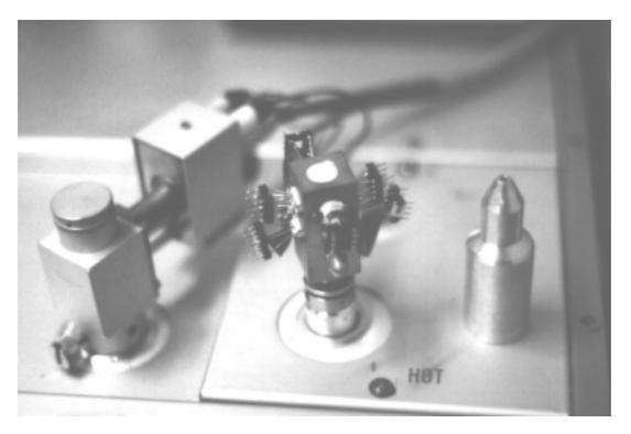
Abb. 2.8: Sensorblock auf der beheizten Detektorbasis des Gaschromatographen
