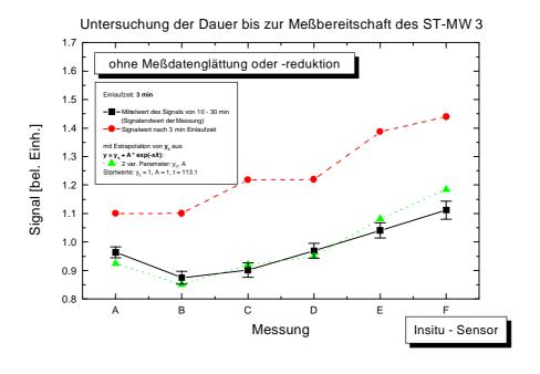
Abb. 3.87: Vergleich des extrapolierten Signals nach 3 min Einlaufzeit mit dem Signal eines eingelaufenen Sensors
