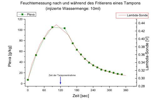
Abb. 3.45: Feuchteverlauf nach Fritieren eines Tampons mit 10 ml Wasserinhalt.
