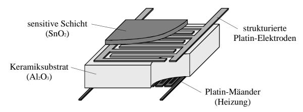
Abb. 1.11: Schematischer Aufbau eines Halbleitersensors mit Interdigitalstruktur (strukturierte Pt-Elektroden) [Lin 96]
