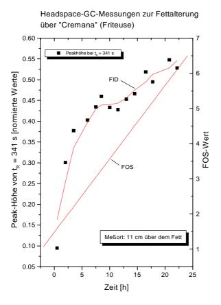
Abb. 3.33: Zunahme der normierten Peakhöhe bei  $t_R = 341 \text{ s}$  mit dem Alter im Vergleich zum Anstieg des FOS
