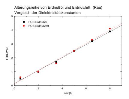
Abb. 3.25 Verlauf des FOS – Wertes mit der Fettalterungsdauer
