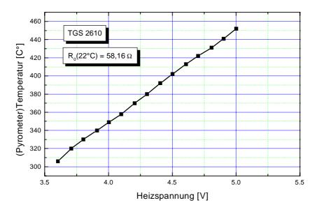
Abb. 3.5: Zusammenhang zwischen Heizspannung  $U_{\rm H}$  und der Substrattemperatur für den TGS 2610
