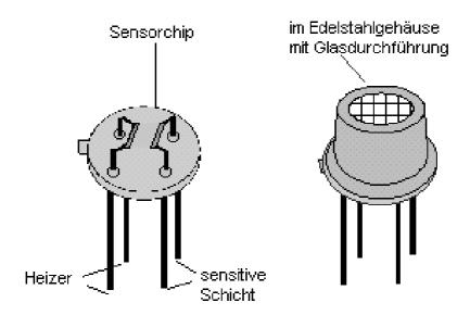
Abb. 2.19: Standardform des Geraberger Gassensors-GGS [Ust 98] Links im Bild sieht man einen Sensor ohne Schutzkappe, rechts einen Sensor mit aufgesetzter Schutzkappe.
