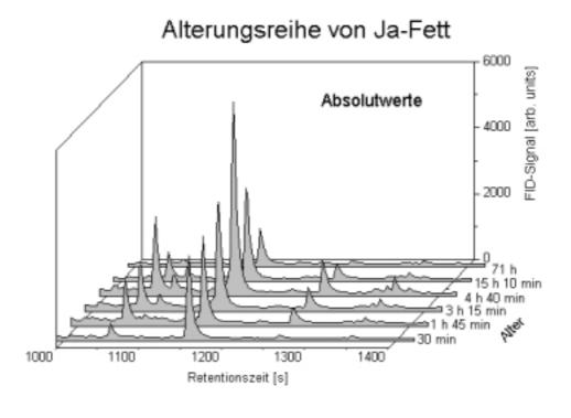
Abb. 3.12: Alterungsreihe von Fett der Marke Ja, dargestellt als 3-d-Diagramm für die Retentionszeit  $t_R = 1000 \text{ s}$  bis 1400 s (gealtert nach der Prozedur 1)
