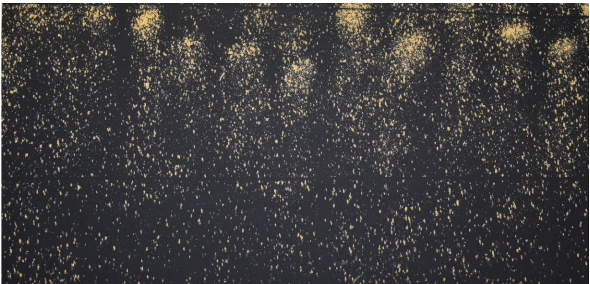
Abb. 20: Zweidimensionale Visualisierung der Trockeneisverteilung während der Simulation „schwerer“ Schaden, hellgelbe Stellen kennzeichnen das Auftreffen des Trockeneises.
