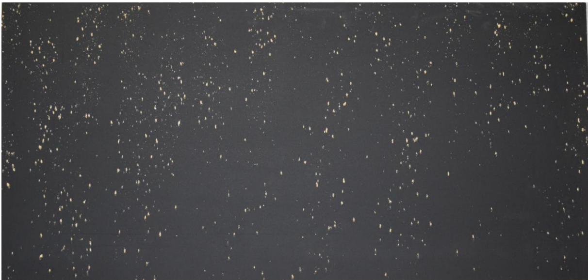
Abb. 18: Zweidimensionale Visualisierung der Trockeneisverteilung während der Simulation „leichter“ Schaden, hellgelbe Stellen kennzeichnen das Auftreffen des Trockeneises.
