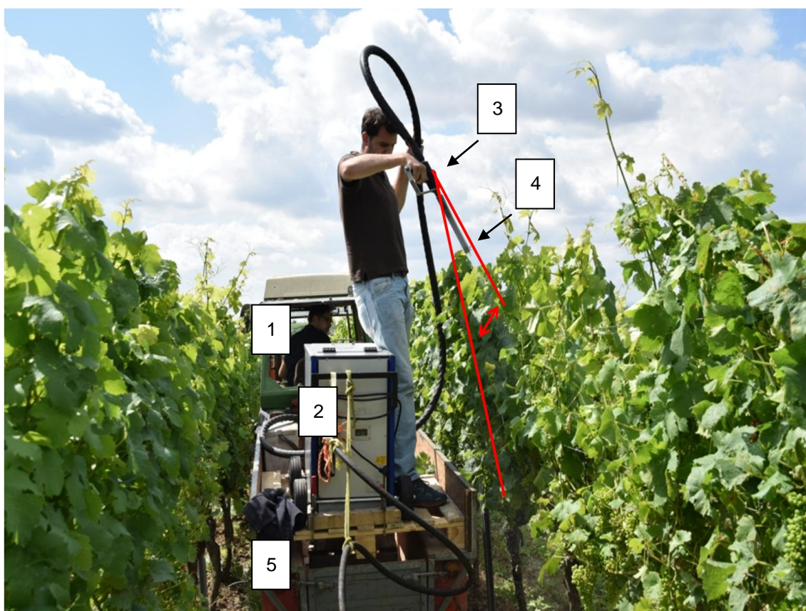
Abb. 17: Visualisierung der Durchführung des künstlichen Hagelschlages in der SHB-Anlage 2016, [1] Traktor mit Fahrer, [2] Trockeneisdosiergerät, [3] anwendergeführte Trockeneispistole, [4] Mündung der Trockeneispistole, [5] Transportanhänger
