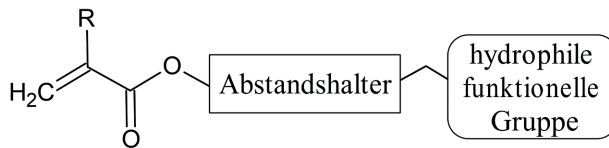
Abb. 3 Vereinfachte chemische Strukturformel eines funktionellen Monomers mit hydrophiler und hydrophober Gruppe sowie den Abstandshalter.
