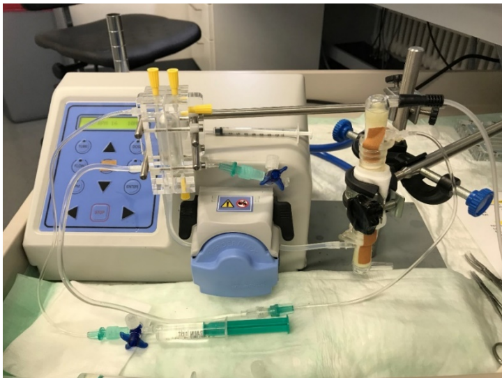
Abb.18: ECMO mit Micro-1-Rat-Oxygenator
