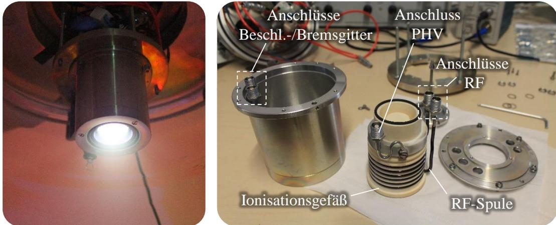
(a) Das RIM-4 im Betrieb (links) und im zerlegten Zustand (rechts).
