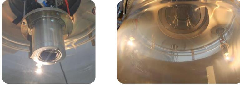
Abbildung 5.3: Darstellung der Neutralisatoren des RIM-4 (links) mit einer Glühwendel und des RIM-10 mit zwei Glühwendeln (rechts).
