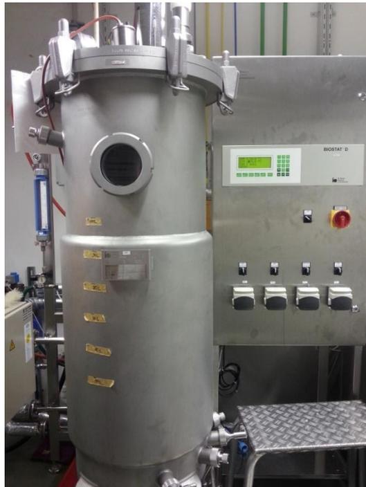
Abbildung 29: 150 L-Bioreaktor zur Submerskultivierung von Basidiomyceten-Mycel.
