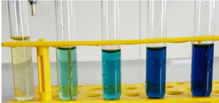
Abbildung 18: N-Acetyl-D-Glucosamin Kalibrierreihe in den Konzentrationen: Wasserblindlösung,  $0,01 \text{ mg mL}^{-1}$ ;  $0,03 \text{ mg mL}^{-1}$ ;  $0,05 \text{ mg mL}^{-1}$ ;  $0,1 \text{ mg mL}^{-1}$  gezeigt von links nach rechts.
