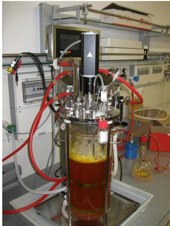
Abbildung 28: 7,5 L Bioreaktor zur Submerskultivierung von Basidiomyceten-Mycel (PSA IM; Kulturtag 3).
