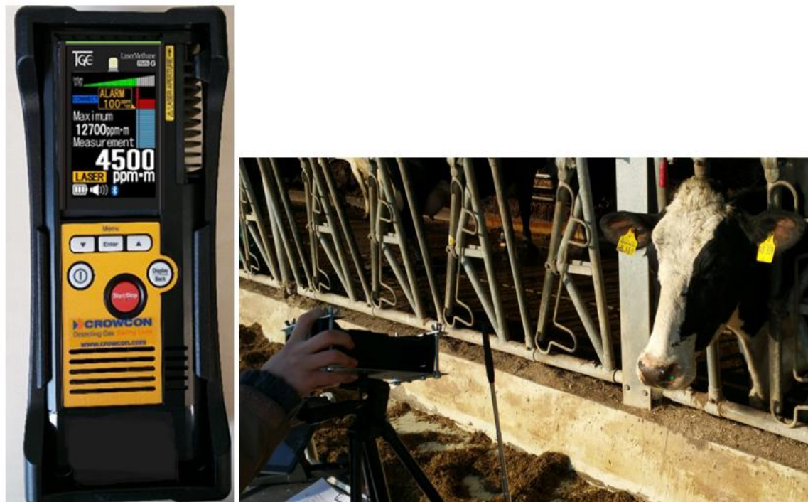
Abbildung 6: Laser-Methan-Detektor (LMD) Detailansicht, links; Methanmessung einer Milchkuh mit einem LMD, rechts
