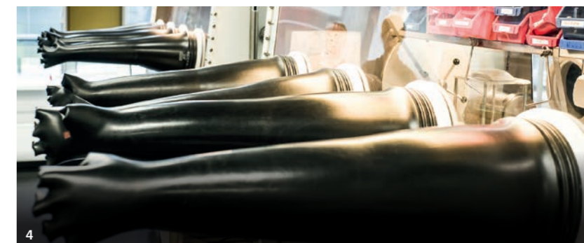
1+3: Dr. Ronja Haas untersucht die Materialstruktur einer laufenden Batterie mit Hilfe von Röntgenbeugung. 2: Synthese von Batteriematerialien im Labormaßstab. 4: Handschuhboxen für die Arbeit an luftempfindlichen (Batterie-)Materialien.
