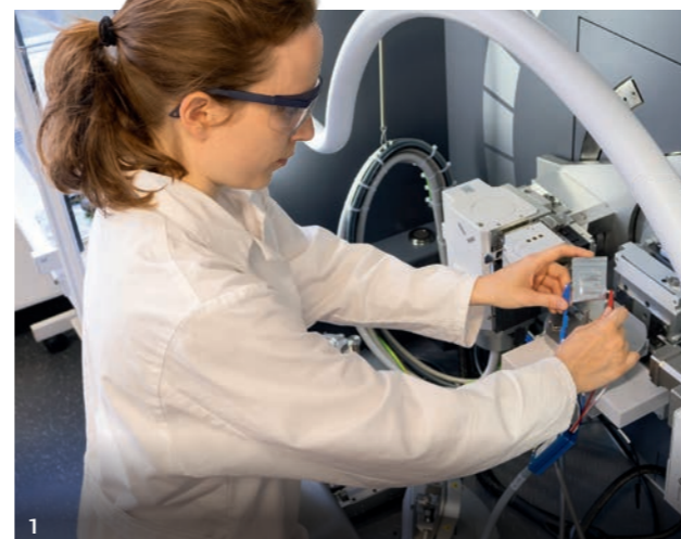
1+3: Dr. Ronja Haas untersucht die Materialstruktur einer laufenden Batterie mit Hilfe von Röntgenbeugung. 2: Synthese von Batteriematerialien im Labormaßstab. 4: Handschuhboxen für die Arbeit an luftempfindlichen (Batterie-)Materialien.
