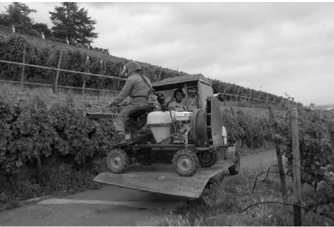
Abb. 6: Versetzen des Geräteträgers
