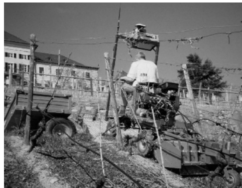
Abb. 63: GPS-Antenne auf dem Geräteträger
