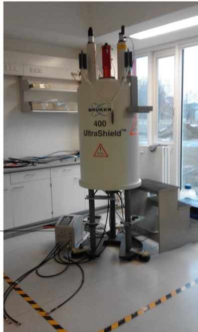
Abbildung 2.3: Aufbau des Grundfeldmagneten. Links: Schematische Darstellung. Ein System konzentrisch angeordneter Spulen erzeugt das Hauptmagnetfeld. Die Kühlung des supraleitenden Magneten erfolgt mit flüssigem Helium und Stickstoff. Die zentrale Säule wird als magnetisches „bore“ (Bohrloch) bezeichnet. Modifiziert nach 11 . Rechts: Fotografie des Systems des Instituts für Molekulare Kardiologie, HHU Düsseldorf. Links neben dem Grundfeldmagneten sieht man den ebenfalls zum Magnetsystem gehörenden Vorverstärker (HPPR).
