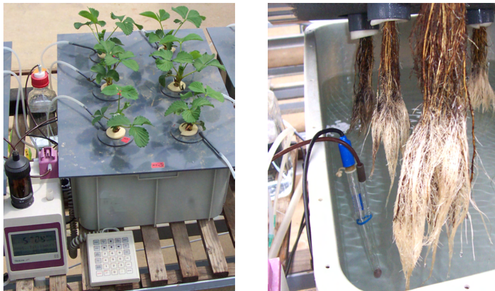
Abb. 5: Anzuchtwanne mit Belüftungsschläuchen, pH-Stat-Anlage und pH-Elektrode mit Dosierspitze
