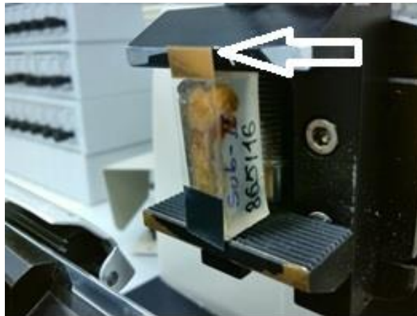
Abbildung 10: Block des eingebetteten Knochens der Subgruppe 2 im Mikrotom mit Kawamoto-Folie (Pfeil zeigt auf nicht klebenden goldenen Teil der Folie)
