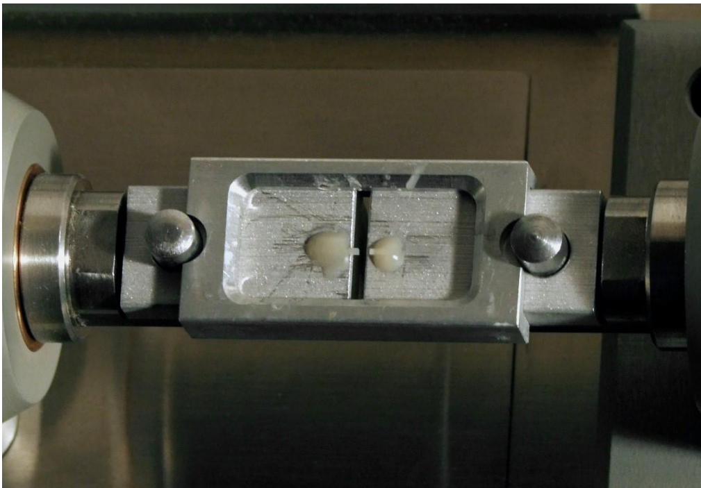
Abb. 9 Aufsicht auf eine frakturierte Probe nach Belastung
