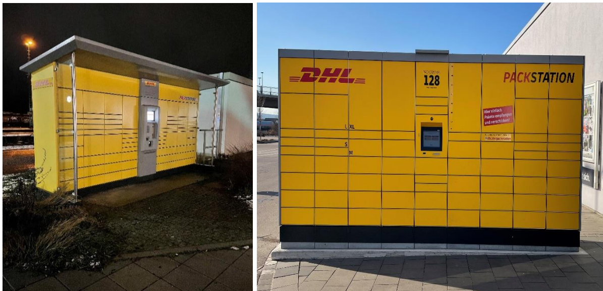
Abbildung 34 Packstation von DHL ohne eigene Lichtinstallation (links) und ohne Witterungsschutz (rechts)
