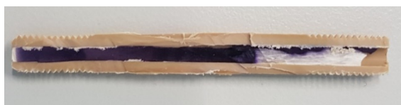
Abbildung 3.34: Querschnitt eines mit einer Ninhydrinlösung eingefärbten aminofunktionalisierten \text{SiO}_2 -Monolithen.
