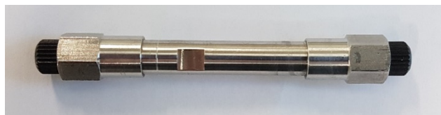
Abbildung 3.58: Mit LiChrospher® Si 60- und Si 100-Partikel gefüllte HPLC-Säule, wie sie im Rahmen der Knoevenagel-Kondensation im Durchfluss verwendet wurde.
