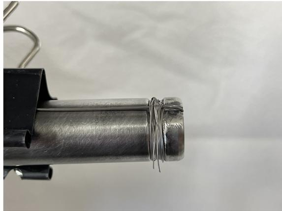
**Abbildung 2.23** – Vielweckklemme als Hilfsmittel für den Gehäusekontakt
