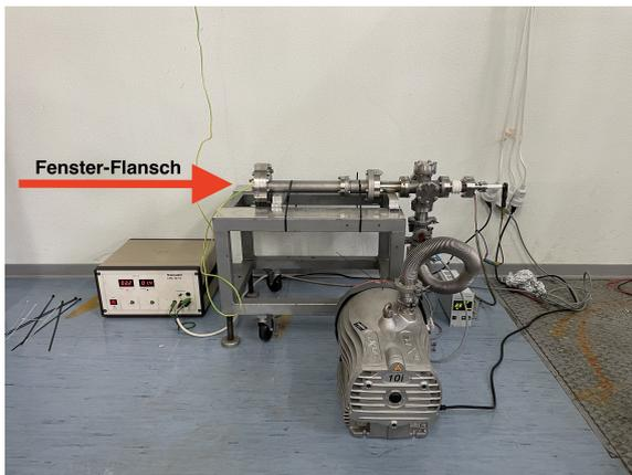
**Abbildung 2.19** – Ofen-Teststand mit eingezeichneter Position des Fensters
