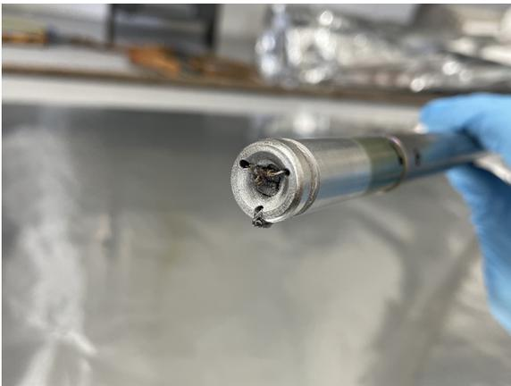
**Abbildung 2.15** – Verschmolzenes Material an der Ofenöffnung.
