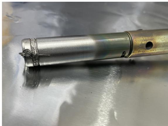
**Abbildung 2.16** – Verschmolzener Titandraht an Ofengehäuse.
