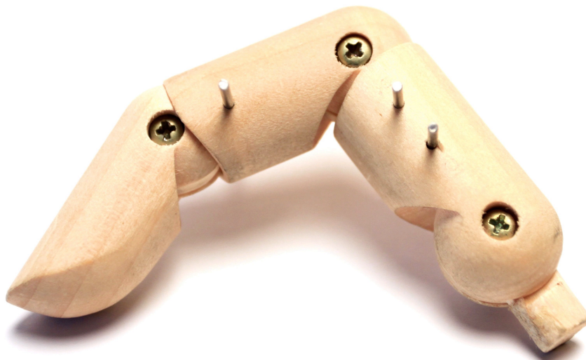
Abbildung 54. Seitansicht Gliederfinger in Funktionsstellung Flexion. Durch die Funktionalität des Gliederfingers konnten die Bewegungsmuster des Fingers mit anliegendem Distraktor nachempfunden werden.
