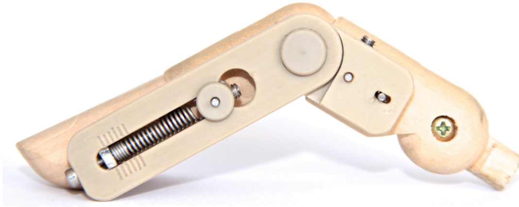
Abbildung 55. Prototyp LigTrac V1 - Angelegt am Bewegungsmodell, Seitenansicht. In der Darstellung wird die Dimension der Bauteile in Bezug auf den Finger ersichtlich.
