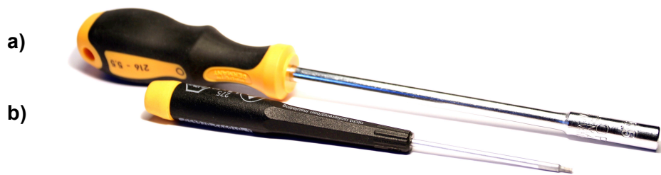
Abbildung 46. a-b Darstellung des handelsüblichen Sechskant-Steckschlüssels (a) und des Sechskant-Schraubendrehers (b), die für die Fixierung und Einstellung des Distraktors benötigt werden.
