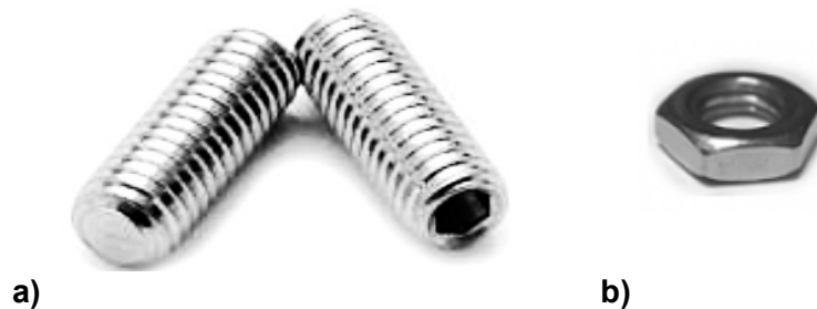
Abbildung 44. a-b a) Darstellung der Verwendeten Gewindestifte mit Innensechskant zur Fixierung der Kirschner Drähte. b) Darstellung der Sechskantmutter, die am proximalen Schenkel als Gegensicherung der 2x10mm Gewindestifte genutzt wird.
