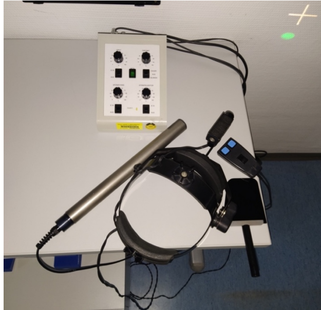
Abbildung 10: Bedienelemente für die Harms-Wand Strabometer mit aufgesetztem Projektionskreuz, links davon der Lichtzeiger, der einen grünen Punkt an die Wand projiziert, Fernbedienung rechts im Bild, Dunkelrotglas-Blende rechts unten, am oberen Bildrand: Steuerbox des Projektors
