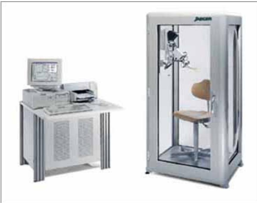
**Abb. 3.8:** Der Universal-Lungenfunktionsmessplatz mit Bodyplethysmograph MasterLab Body Pro® der Fa. Erich Jaeger GmbH, Würzburg. [Graphik: <http://www.jaeger-toennies.com>]
