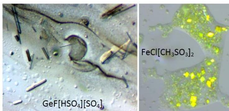
Abbildung 72: Lichtmikroskopische Aufnahmen der farblosen Kristalle von  $\text{GeF}[\text{HSO}_4][\text{SO}_4]$  und der gelben Kristalle von  $\text{FeCl}[\text{CH}_3\text{SO}_3]_2$ .
