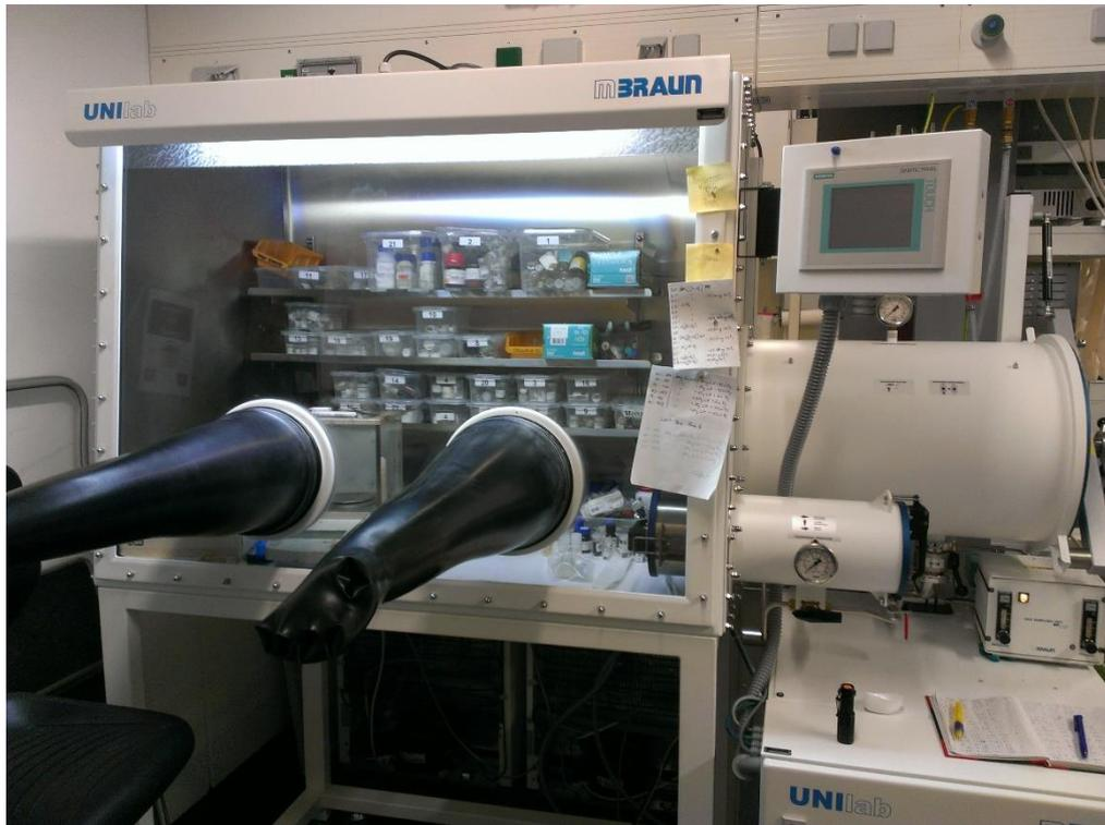
Abbildung 9: Handschuhbox mit zwei Schleusen rechts am Boxenkörper.
