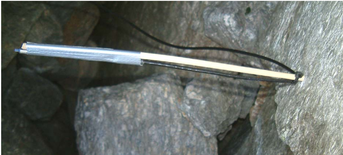
Abb. 3.2 Lufttemperatursensor (offener Sensortyp) und Beispiel für die Art der Installation im Ritigraben-Blockfeld (Aufnahme: R. Hof, Juni 2003)
