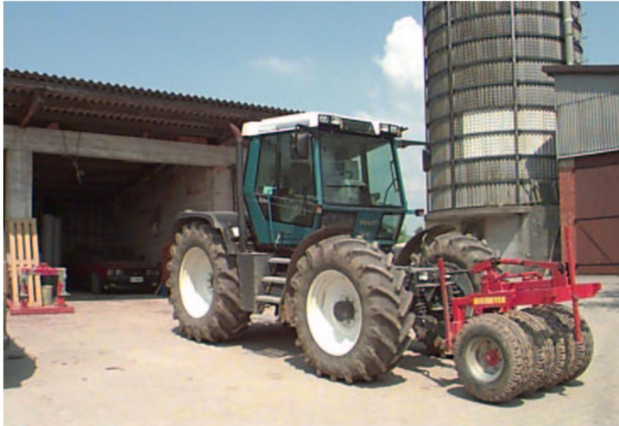
Abbildung 5.11: Versuchsträger mit Frontpacker
