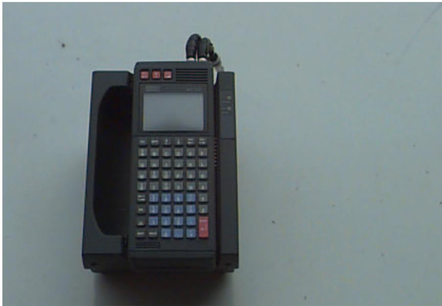
Abbildung 5.12: Pision Data-Logger zur Versuchsaufzeichnung
