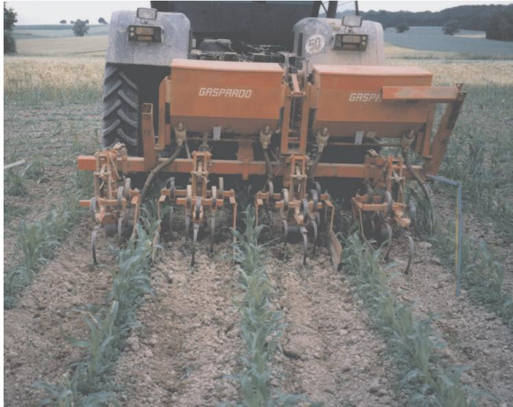
Abbildung 6.2: Maishacke zur visuellen Funktionskontrolle des Lenkautomaten
