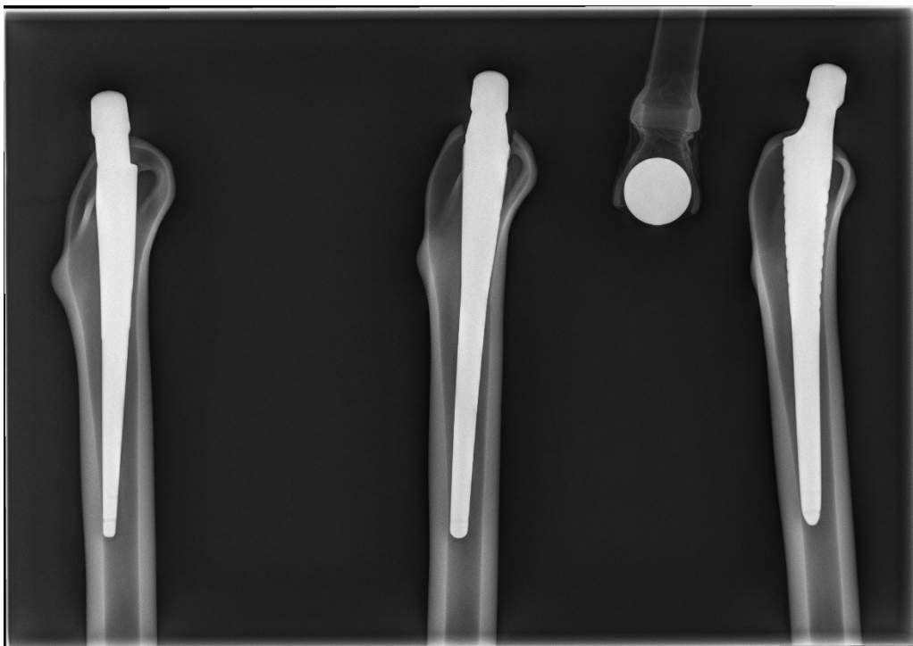
Abbildung 32: Röntgenbild in medial-lateral Strahlengang; von links nach rechts EcoFit®, CLS® Spotorno® und TrendHip®
