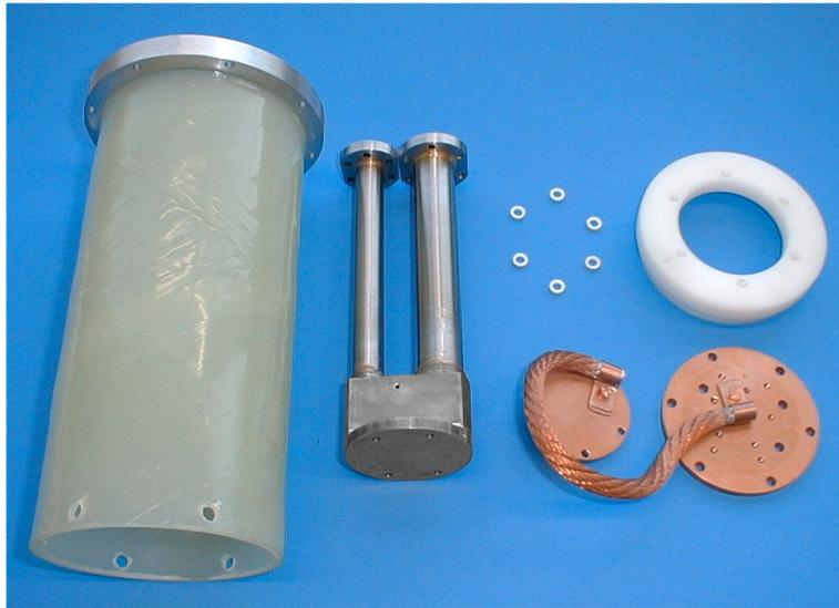
**Abbildung 7.15.:** Passive Vibrationsdämpfung durch ein GFK-Zylinder und spiralgewundenes Kupferkabel (*Methode 3*)
