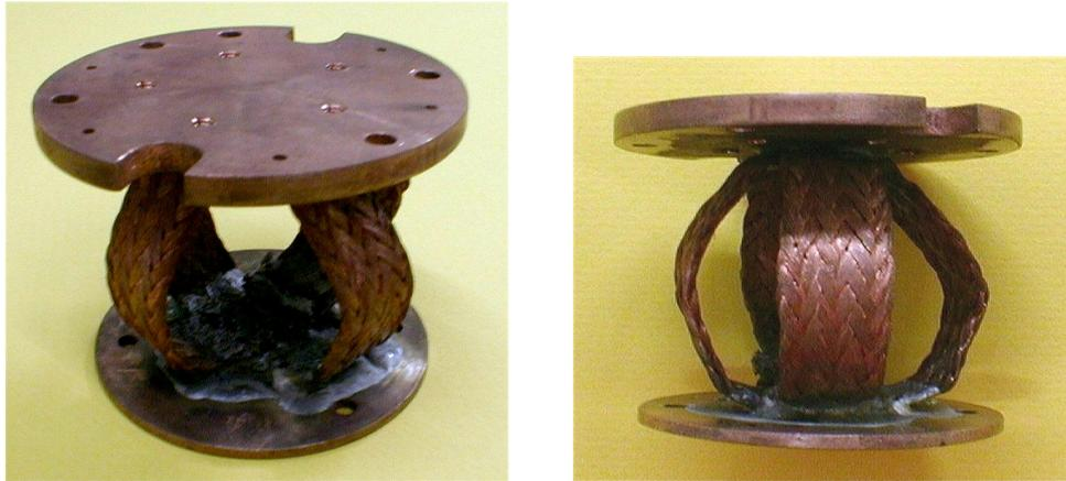
**Abbildung 7.9.:** Passive Vibrationsdämpfung durch flexible Kupferlitze - Methode #1
