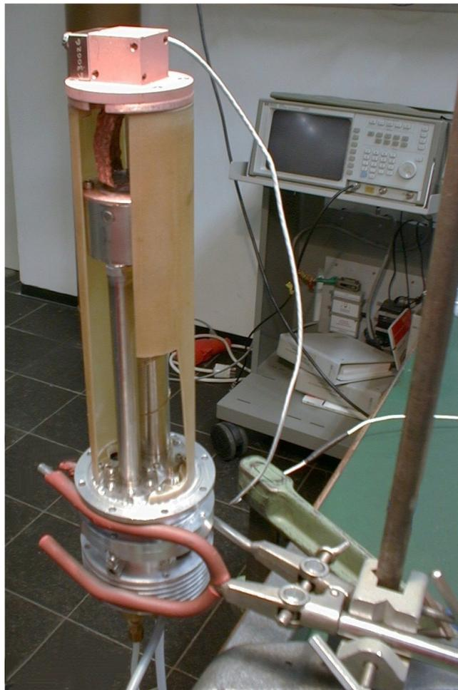
**Abbildung 7.10.:** Gesamtaufbau des Ti-PRK mit passiver Vibrationsdämpfung durch flexible Kupferlitze (*Methode 1*)
