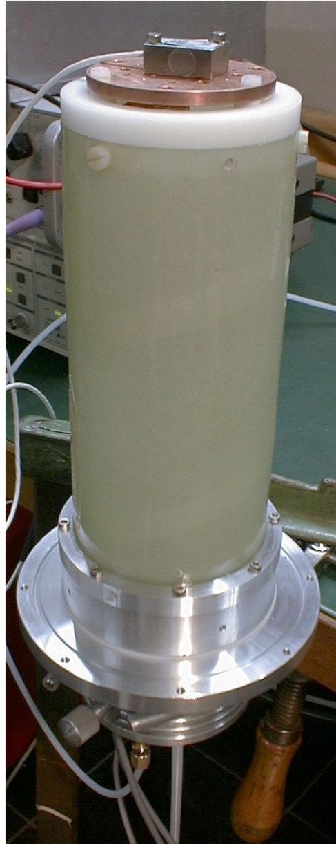
**Abbildung 7.16.:** Gesamtaufbau des Ti-PRK mit passiver Vibrationsdämpfung mittels GFK-Zylinder und spiralgewundenem Kupferkabel (*Methode #3*)
