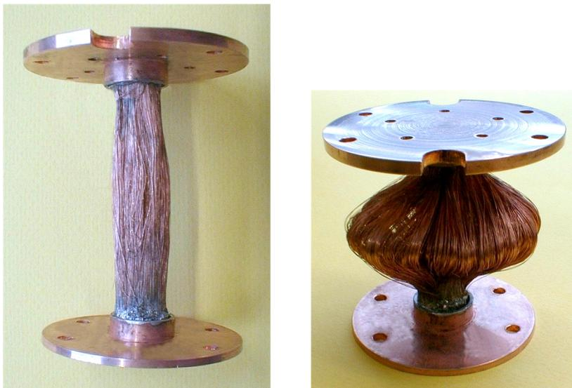
**Abbildung 7.12.:** Passive Vibrationsdämpfung durch gestauchte dünne Kupferdrähte - Methode 2
