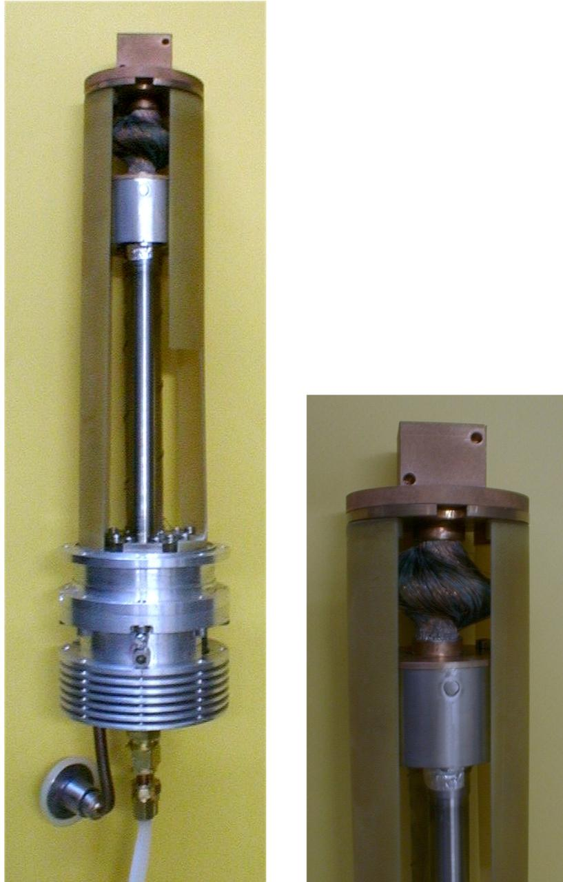
**Abbildung 7.13.:** Gesamtaufbau des Ti-PRK mit passiver Vibrationsdämpfung durch gestauchte dünne Kupferdrähte nach Methode 2
